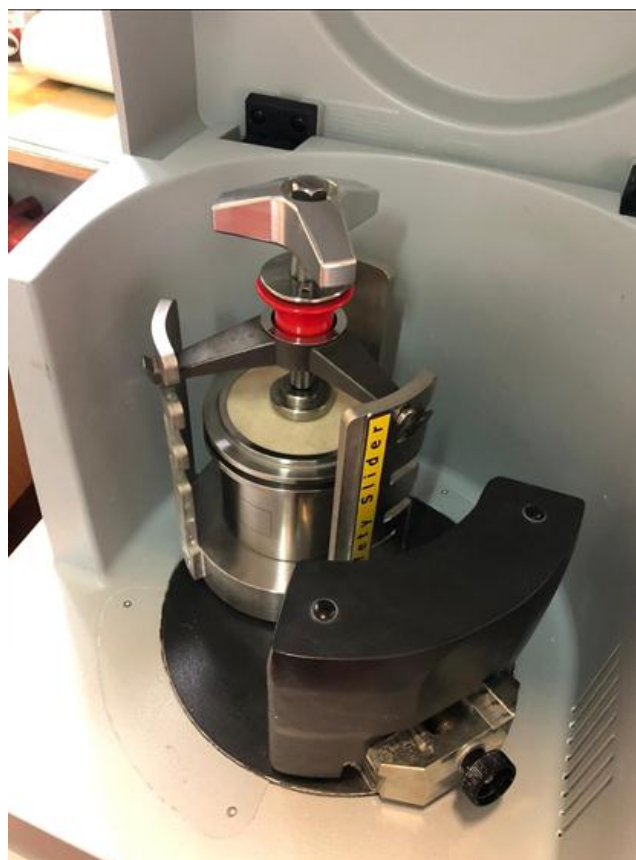
Slika 12. Pozicioniranje posude za miješanje u planetarnom kugličnom mlinu (PM 100, Retsch GmbH, Njemačka)
