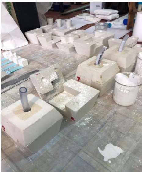
Slika 12. Gipsani kalupi za lijevanje suspenzija
