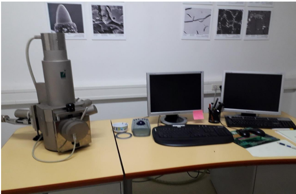
Slika 16. Skenirajući elektronski mikroskop (SEM) Tescan
