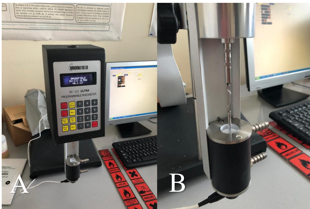
Slika 11. Viskozimetar Brookfield DV-III Ultra (A); Vreteno s pripadajućom komorom(B)
