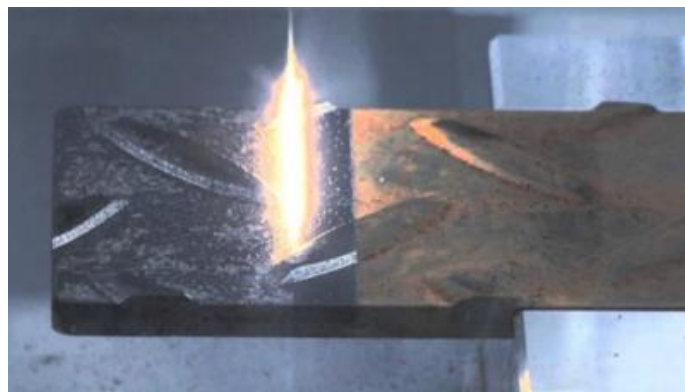
Slika 4.2 Čišćenje laserskom zrakom [9]
