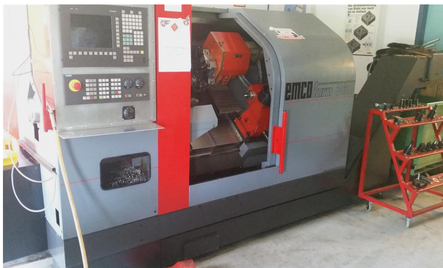
Slika 15. CNC tokarski stroj, EMCO Turn 360
