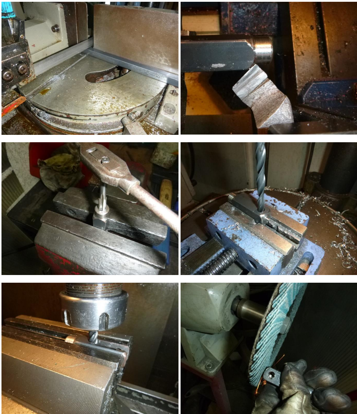
Slika 3. Prikaz postojećeg načina izrade vilice
