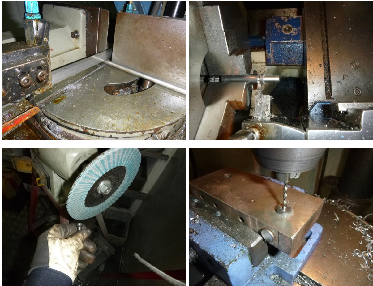
Slika 4. Prikaz postojećeg načina izrade svornjaka
