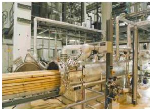
Slika 4.4. Komora za kemijsku modifikaciju drva [21]
