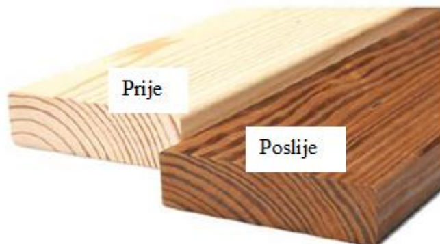
Slika 4.3. Promjena boje na uzorku od jelovine nakon toplinskog modificiranja [21]
