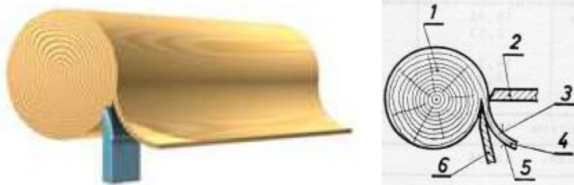
Slika 6.10. Način dobivanja ljuštenog furnira: 1) trupac, 2) pritisna greda, 3) pritisnuta strana, 4) list furnira, 5) otpuštena strana, 6) nož [30]
