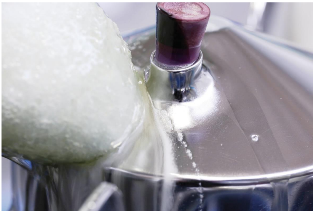
Slika 17. Elektropoliranje tamponskim postupkom [16]
