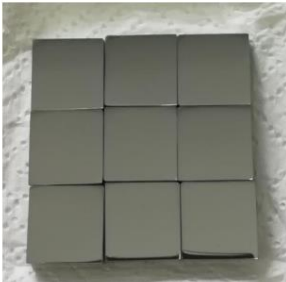
Slika 20. Ispitni uzorci nakon mehaničke predobrade
