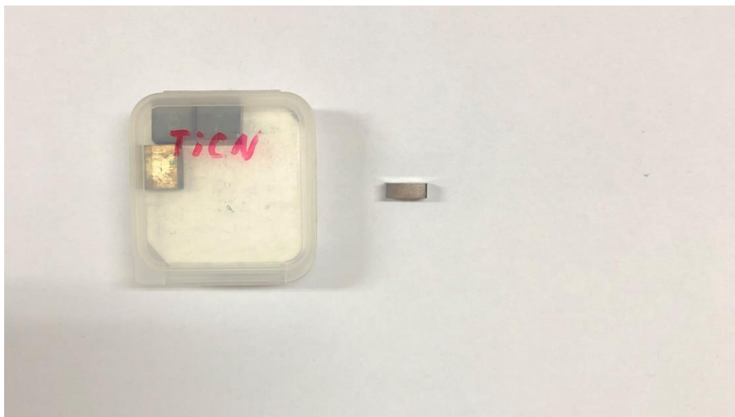
Slika 5.1. Uzorak tvrdog metala s 15% kobalta prevučen TiCN prevlakom
