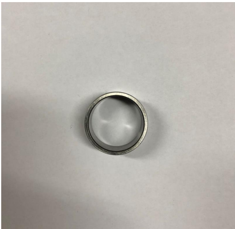
Slika 5.4. Vanjski prsten igličastoga ležaja 1R30X35X17
