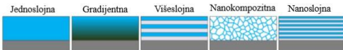
Slika 4.7. Vrste tvrdih prevlaka [14]
