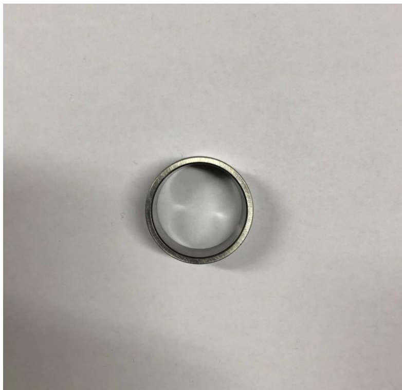
Slika 5.4. Vanjski prsten igličastoga ležaja 1R30X35X17
