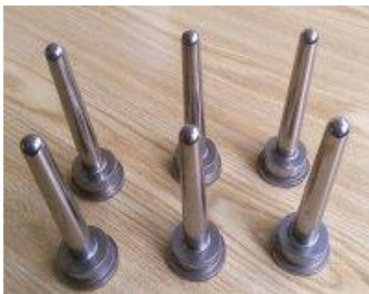
Slika 4.10. Primjer TiBN prevlake [18]
