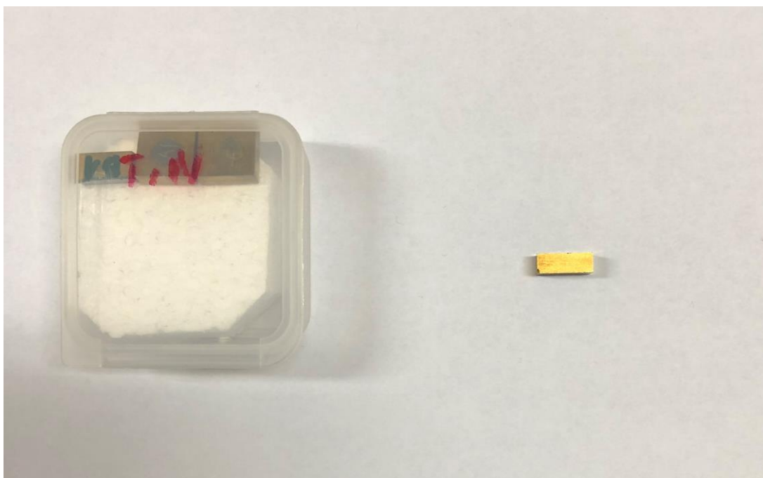
Slika 5.2. Uzorak tvrdog metala s 10% kobalta prevučen TiN prevlakom
