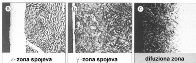
Slika 5. Mikrostruktura zone spojeva i difuzijske zone [6]
