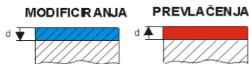
Slika 1. Razlika između modificiranja i prevlačenja [3]
