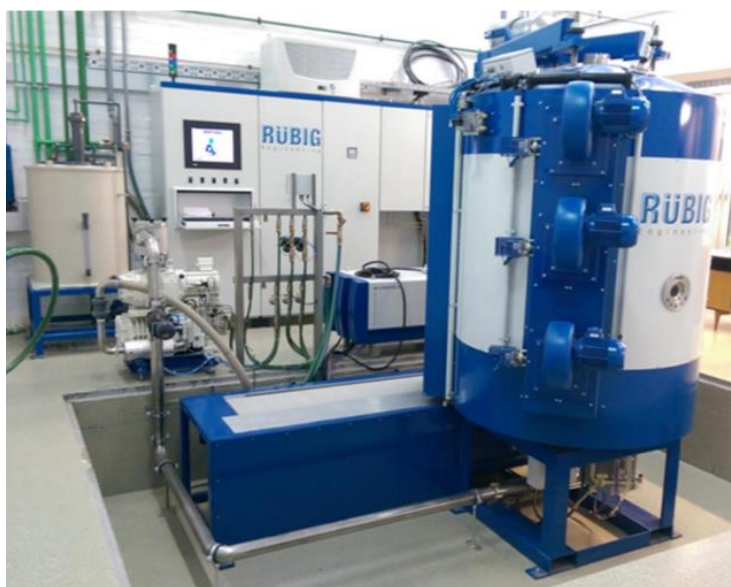
Slika 14. Uređaj MICROPULS PACVD (70/90) [14]
