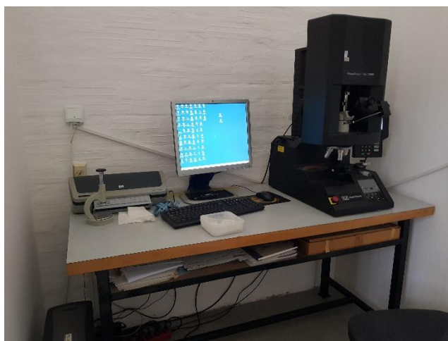
Slika 28. Wilson – Wolpert Tukon 2100B (INSTRON)
