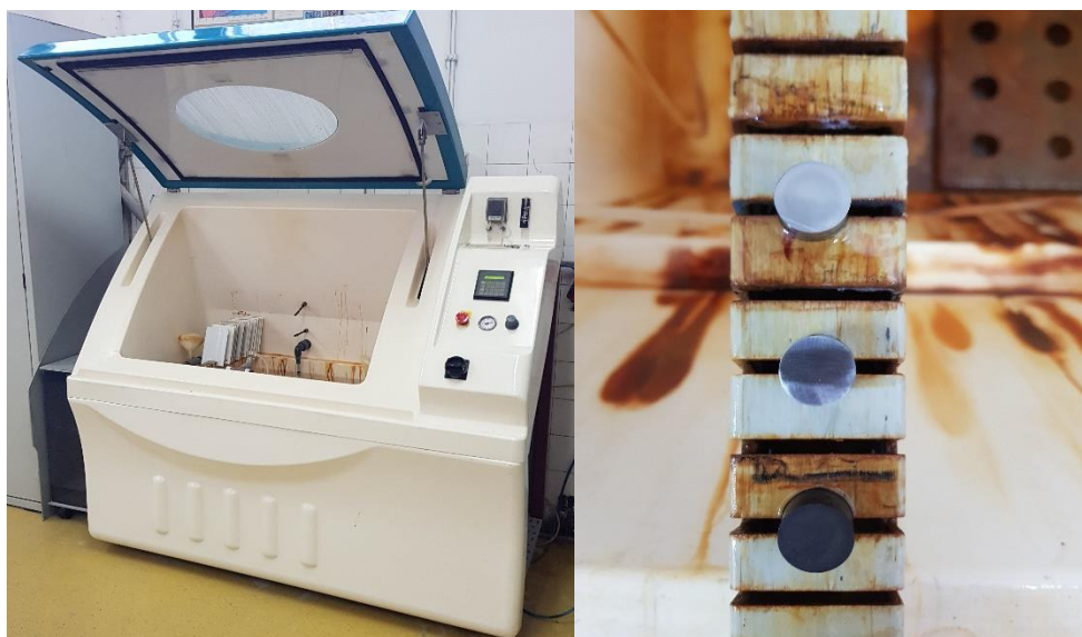
Slika 24. Ispitivanje uzoraka u slanoj komori
