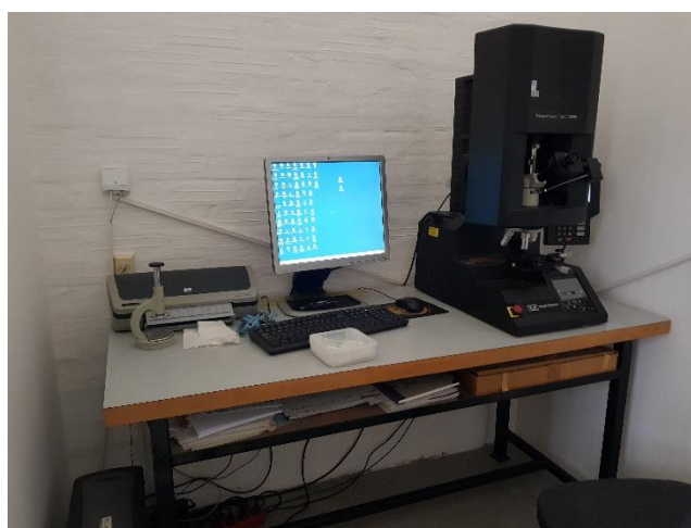
Slika 28. Wilson – Wolpert Tukon 2100B (INSTRON)
