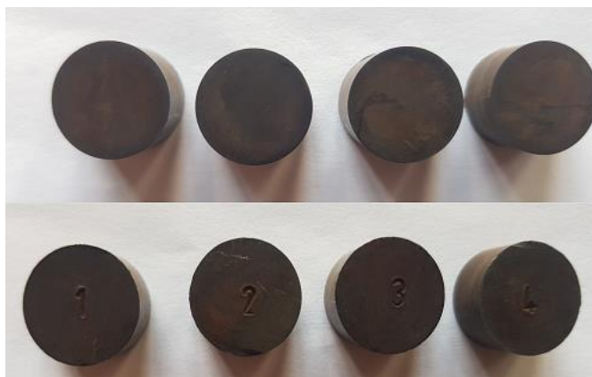
Slika 18. Oksidirane površine uzoraka
