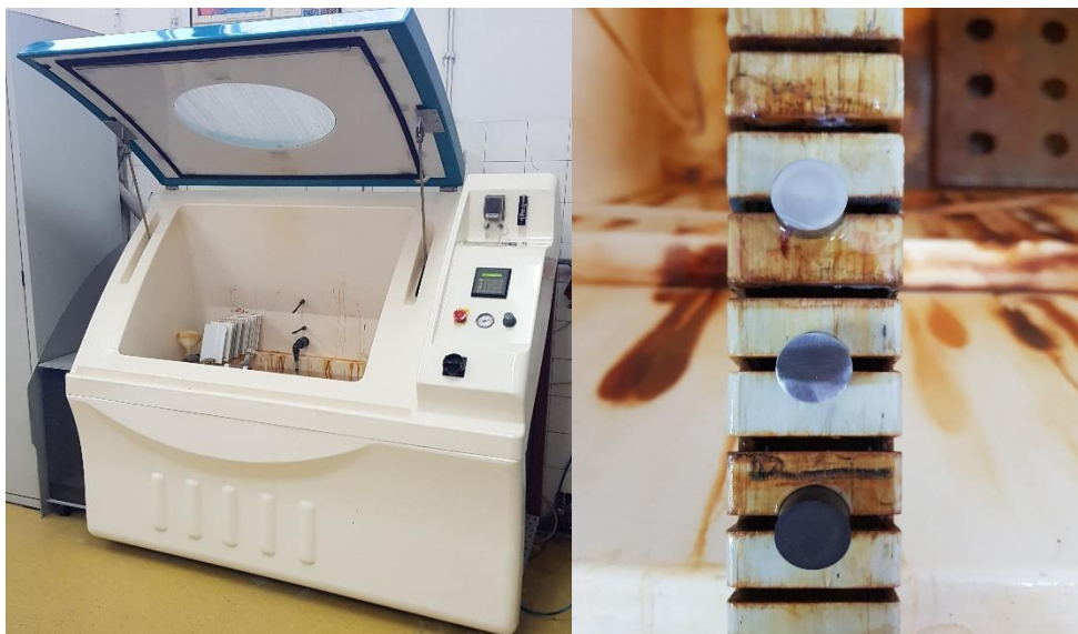
Slika 24. Ispitivanje uzoraka u slanoj komori
