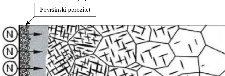
Slika 4. Izgled nitriranog sloja [6]
