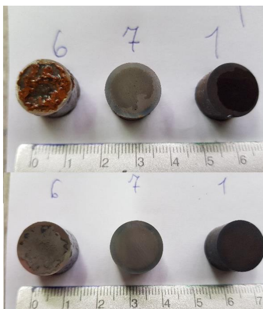
Slika 23. Uzorci nakon 24h u vlažnim uvjetima prije (gore) i poslije (dolje) pranja i sušenja
