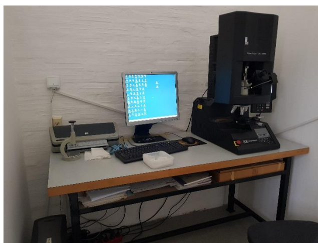
Slika 28. Wilson – Wolpert Tukon 2100B (INSTRON)
