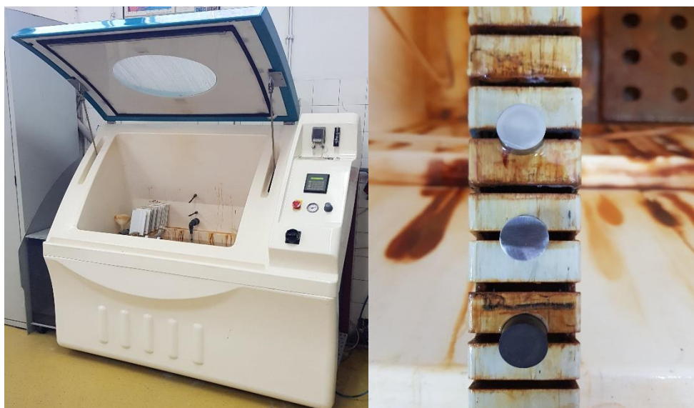
Slika 24. Ispitivanje uzoraka u slanoj komori
