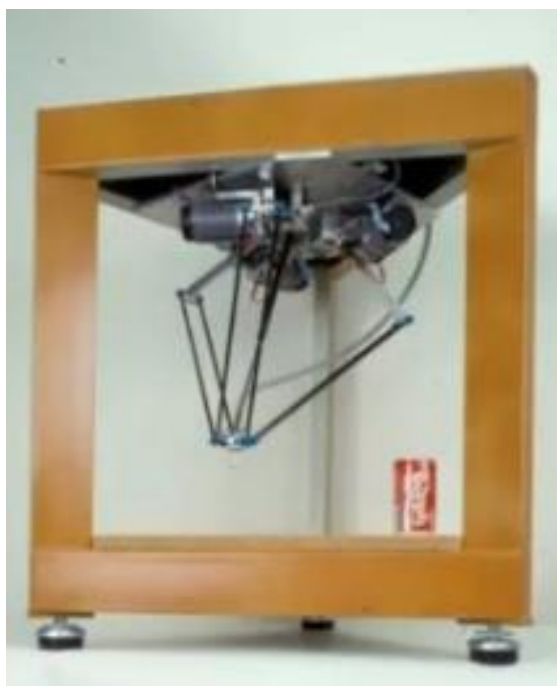
Slika 2. Prvi prototip delta robota (siječanj 1986)
