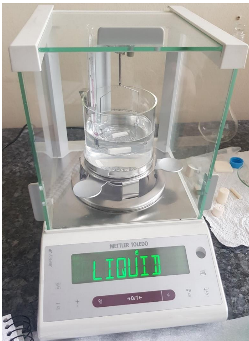
Slika 24. Uređaj za mjerenje gustoće uzoraka- METTLER TOLEDO
