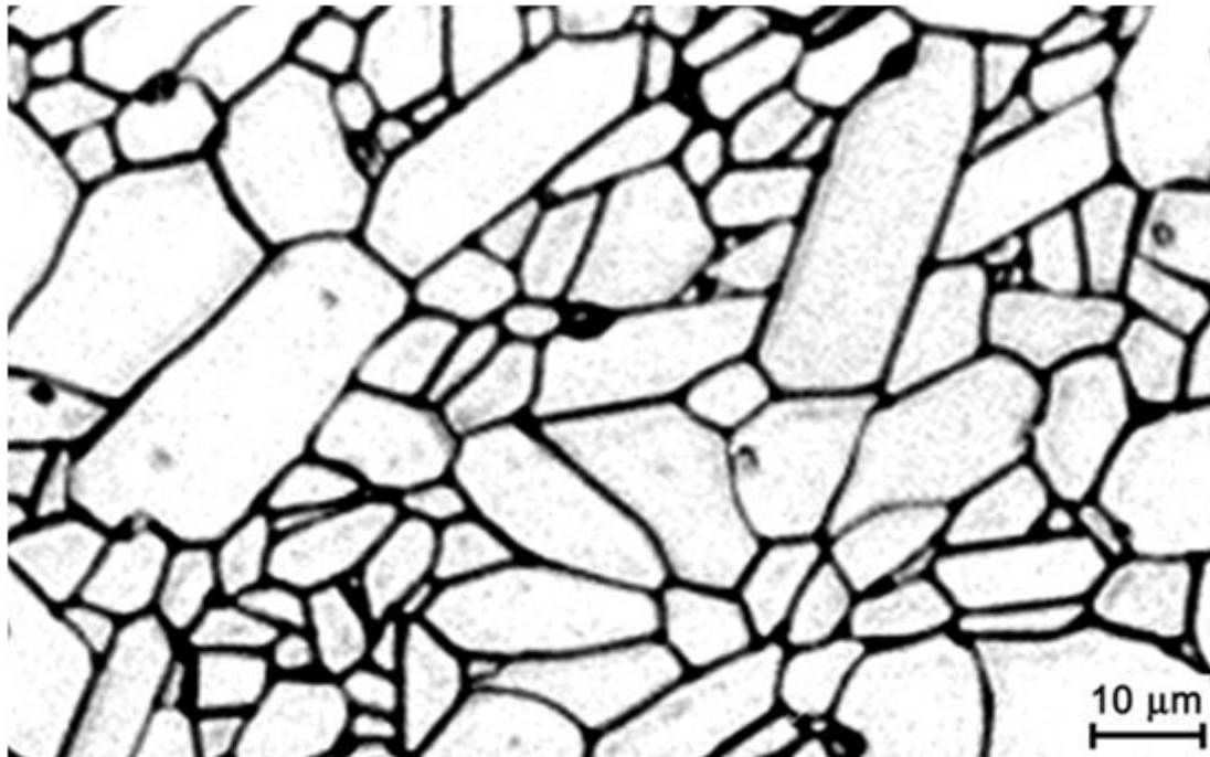
Slika 5. Mikrostruktura aluminij-oksidne keramike (99,7%) [1]
