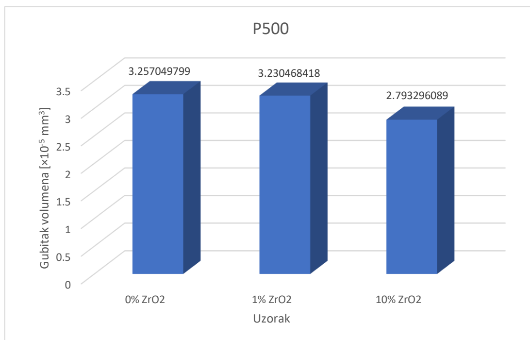
Slika 32. Gubitak volumena na brusnom papiru P500
