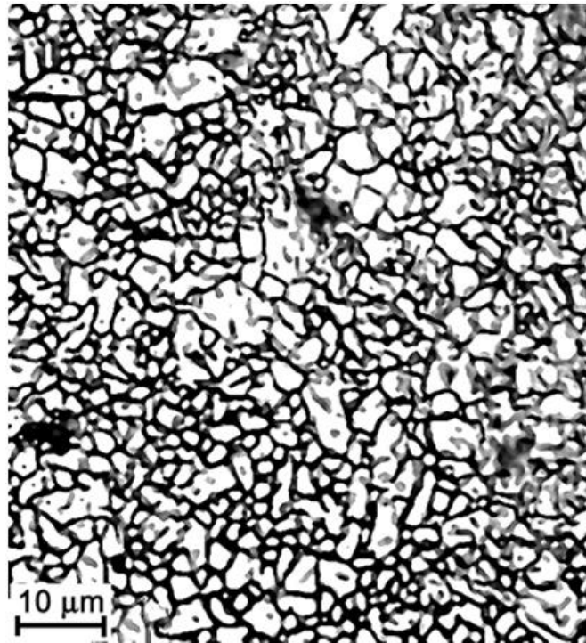
Slika 6. Mikrostruktura aluminijske oksidne keramike s vrlo finim kristalima [1]
