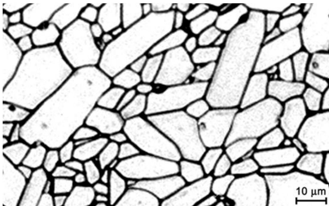
**Slika 5.** Mikrostruktura aluminij-oksidne keramike (99,7%) [1]
