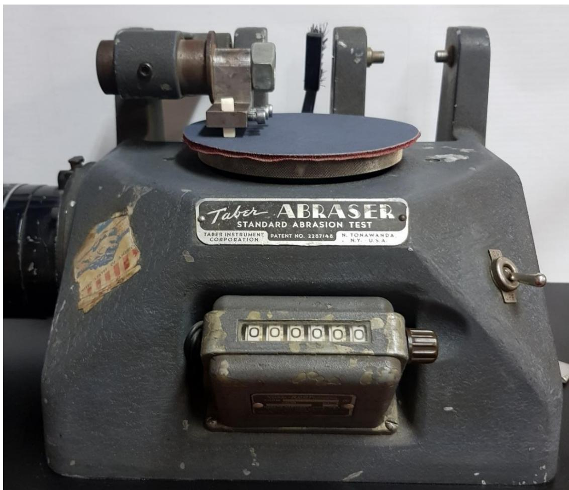
Slika 25. Uredaj za ispitivanje otpornosti na trošenje
