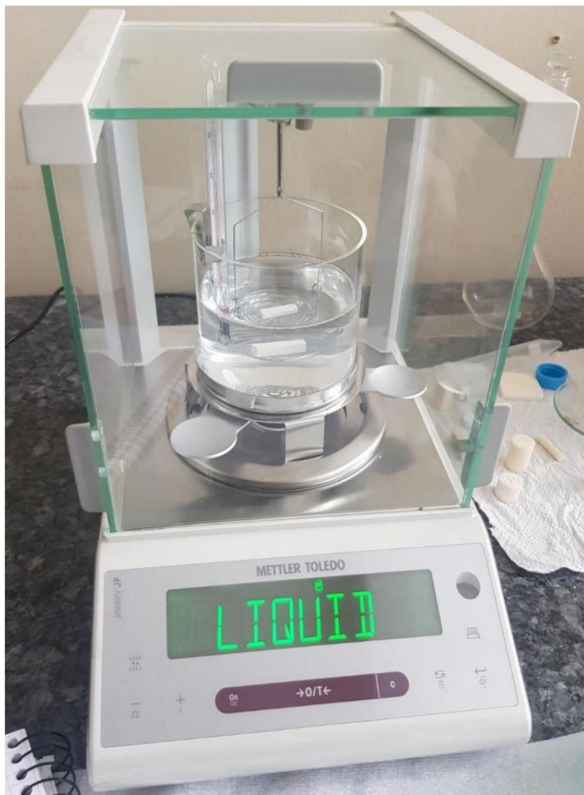
Slika 24. Uređaj za mjerene gustoće uzorka- *METTLER TOLEDO*
