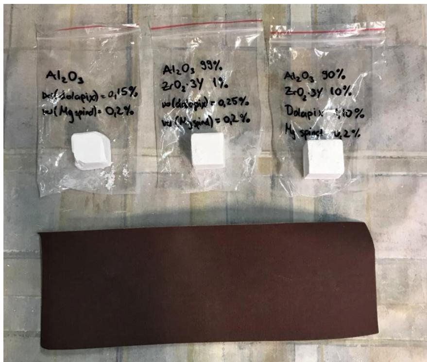
Slika 14. Priprema uzorka za brušenje
