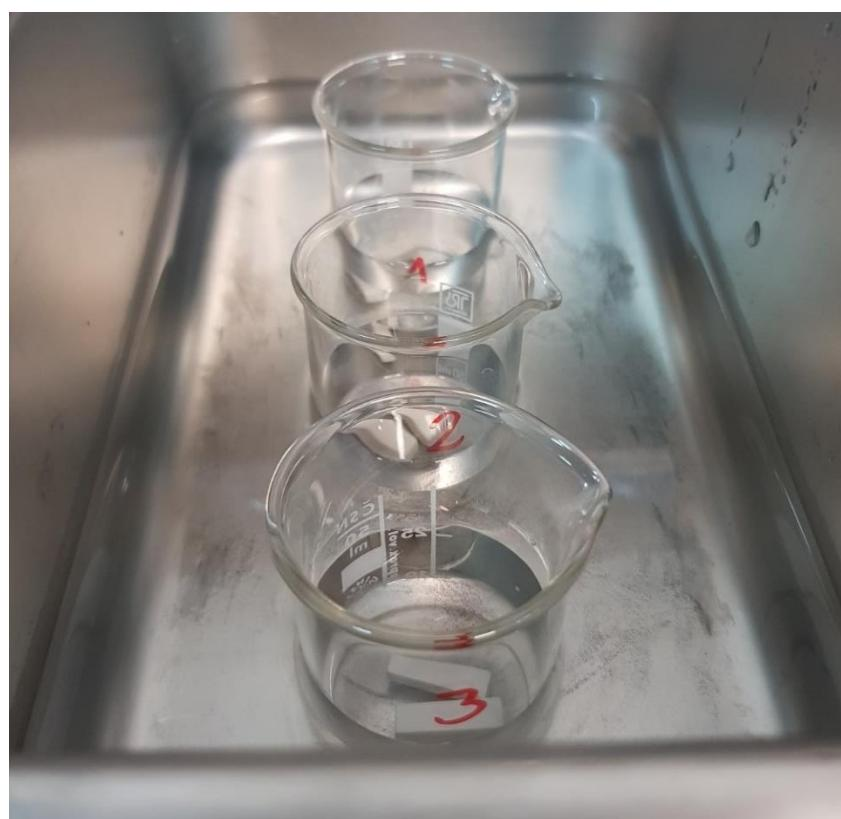
Slika 20. Čišćenje uzorka u ultrazvučnom čistaču
