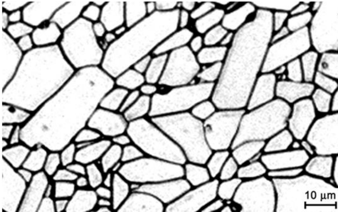
Slika 5. Mikrostruktura aluminij-oksidge keramike (99,7%) [1]
