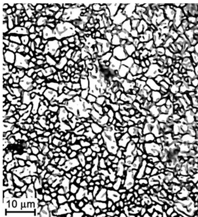
Slika 6. Mikrostruktura aluminij-oksidne keramike s vrlo finim kristalima [1]
