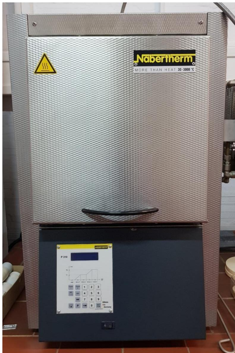
Slika 16. Nabertherm - peć za sinteriranje
