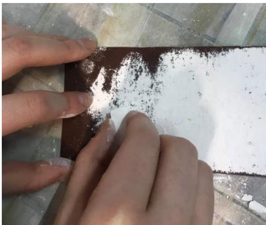
Slika 15. Brušenje uzorka
