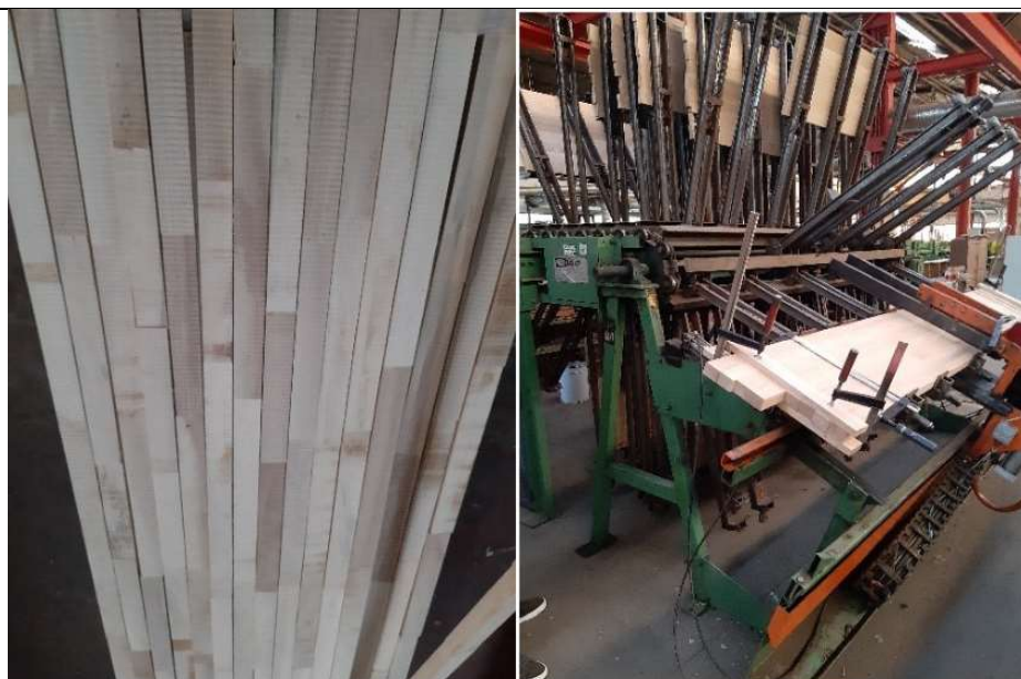
Slika 6-11 Gotovi dužinski elementi i prešanje dužinskih elemenata u ploču
