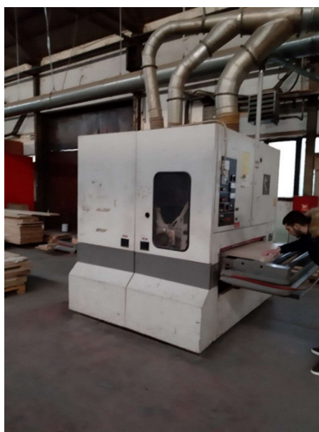
Slika 6-12 Stroj za dvostrano blanjanje ploča
