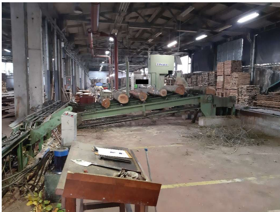
Slika 6-3 Postrojenje za piljenje trupaca
