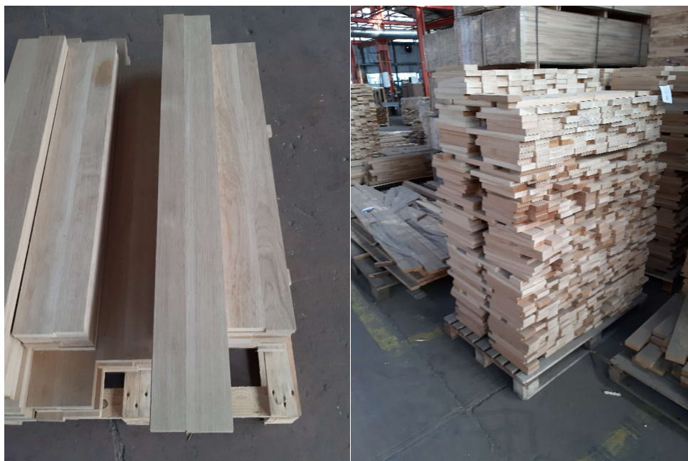
Slika 6-7 Dužinske lamele i cink lamele
