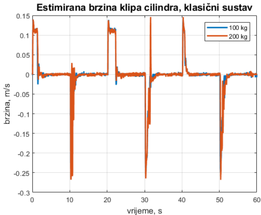
Slika 19. Estimirana brzina klipa cilindra za proporcionalni sustav
