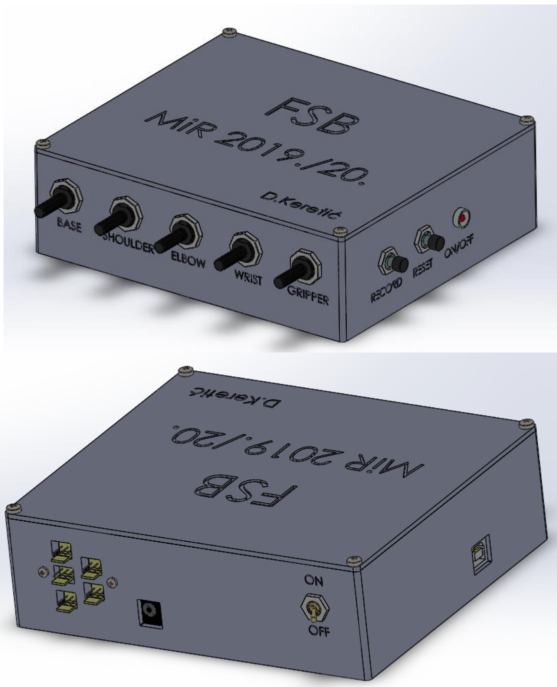
Slika 42. 3D model kučišta
