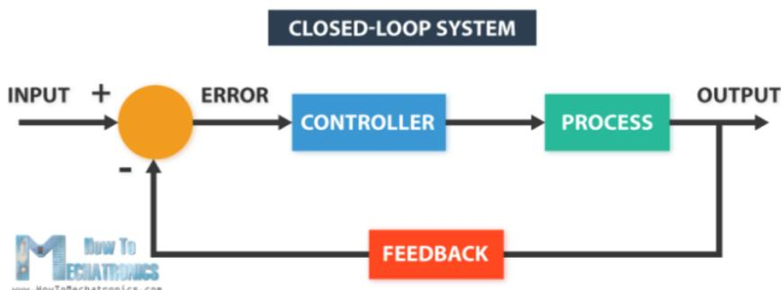
Slika 21. Regulacijski krug servo motora [6]
