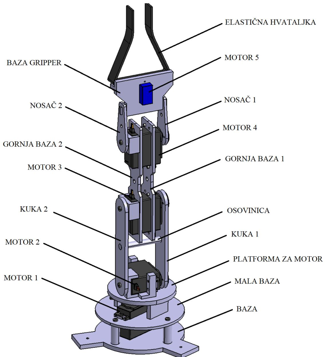
Slika 13. Sklop robotske ruke
