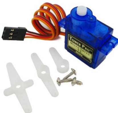
Slika 28. Tower Pro SG90 servo motor [6]
