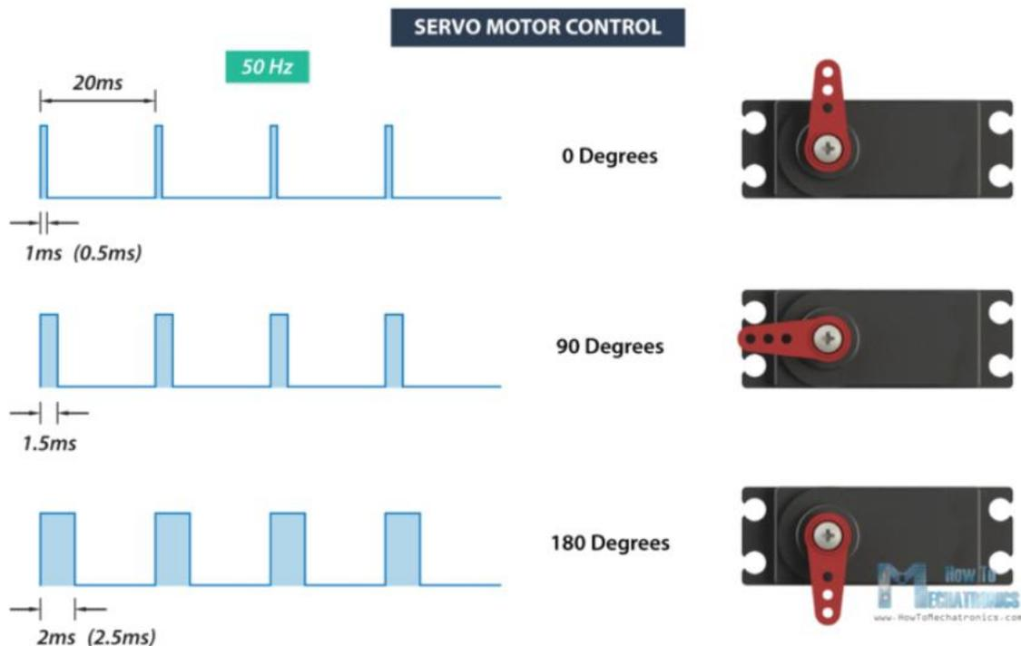
**Slika 23. PWM signal kod servo motora [6]**
