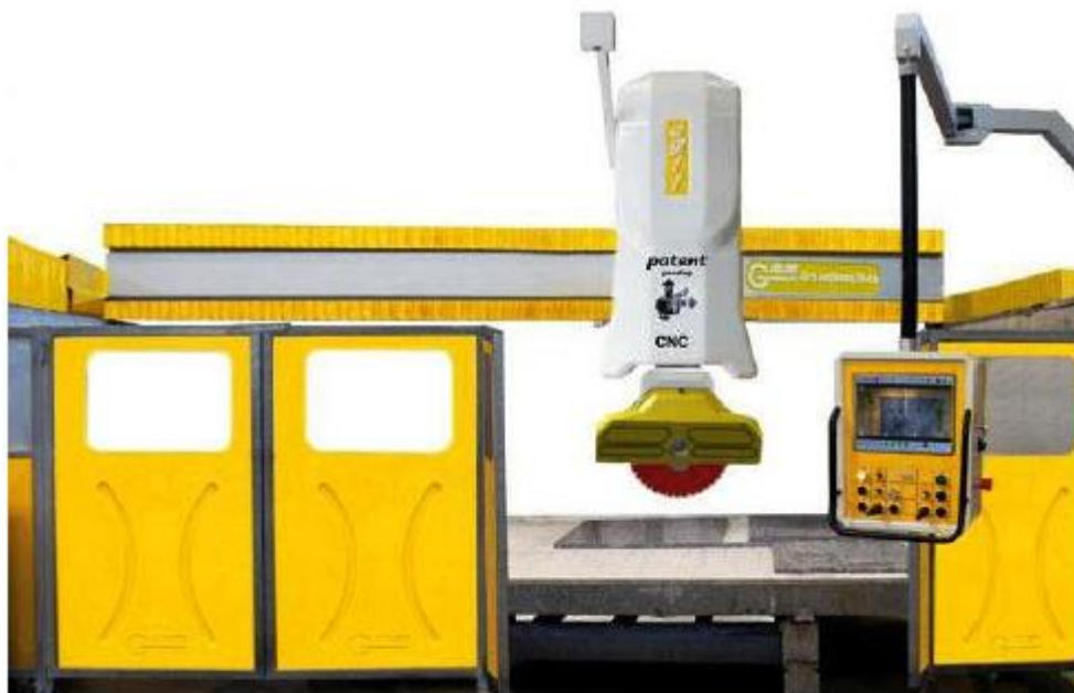
Slika 6. Numerički upravljani portalni stroj za rezanje kamena [7]
