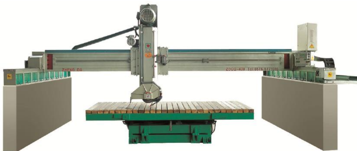
Slika 5. Portalni stroj za rezanje kamena [7]
