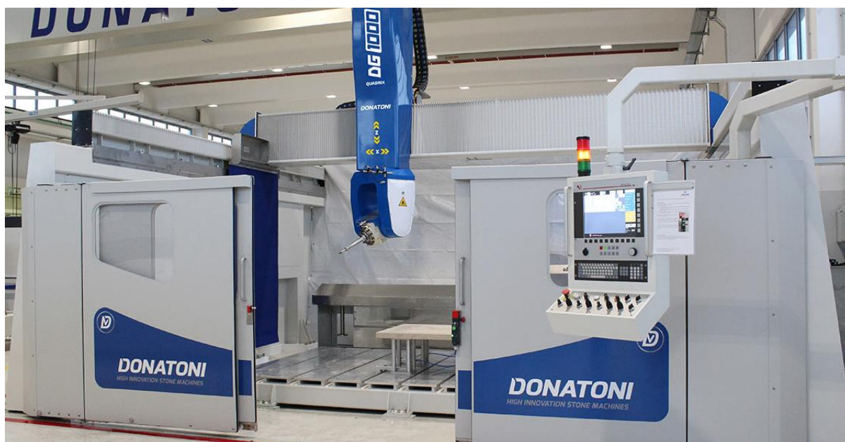
Slika 8. Više osni obradni centar za glodanje kamena [8]
