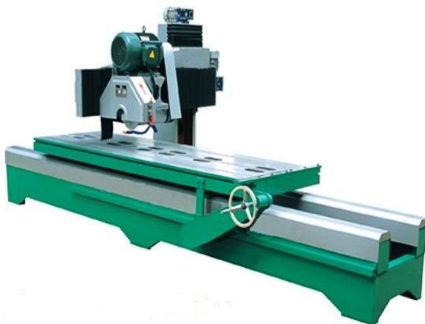
Slika 4. Konzolni stroj za rezanje kamena [7]
