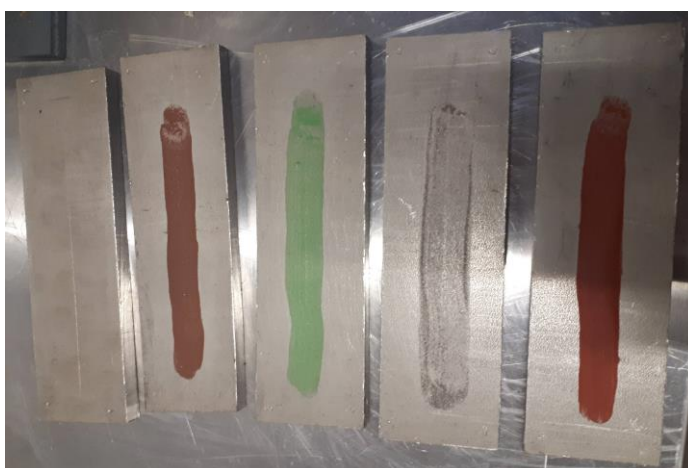
Slika 21. Pripremljeni uzorci s nanešenim aktivacijskim premazima
