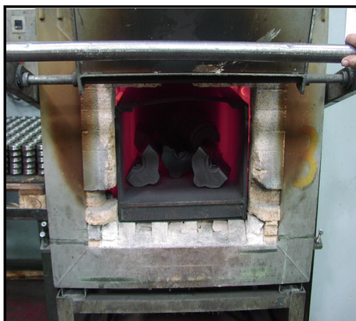
Slika 4.1.2. Zagrijavanje polovica kalupa u specijalnoj peći
