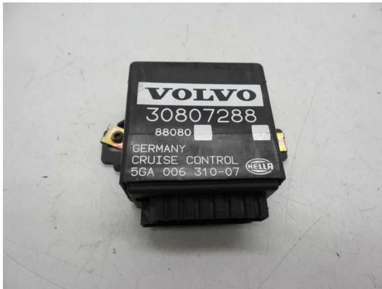
Slika 3.3. Računalo tempomata tvrtke Volvo [12]
