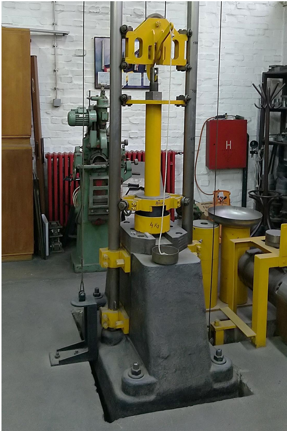
Slika 33. Gravitacijski bat FSB-a
