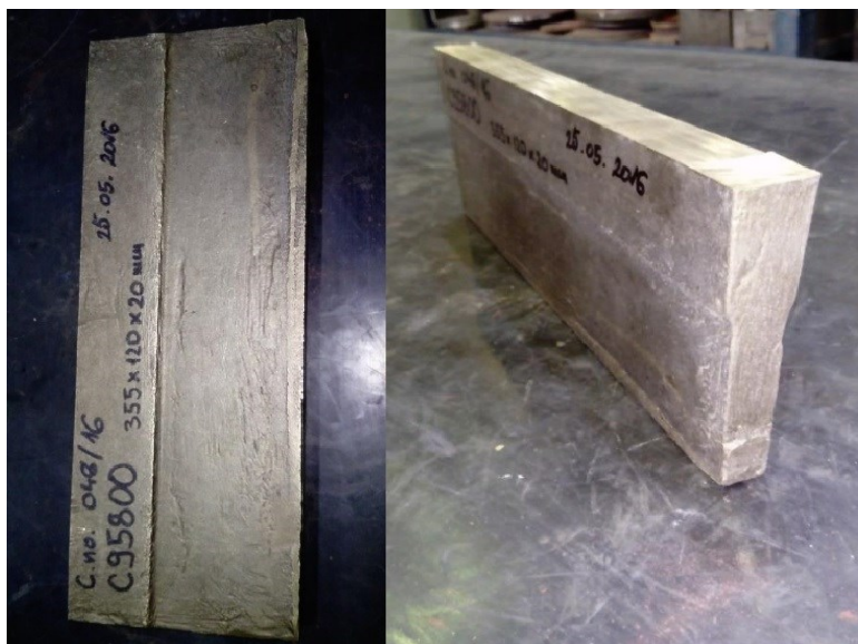
Slika 12. Osnovni materijal – odljevak CuAl10Fe5Ni5
