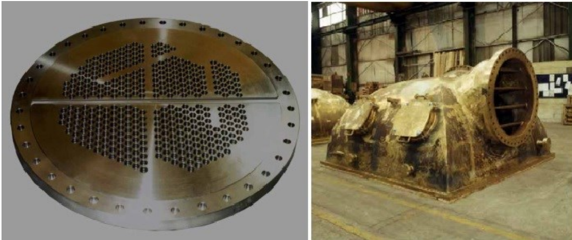
Slika 7. Poklopac kondenzatora i kućište kondenzatora od aluminijske bronce [5]
