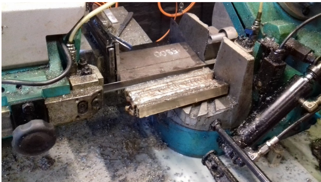
Slika 26. Rezanje ploča na tračnoj pili
