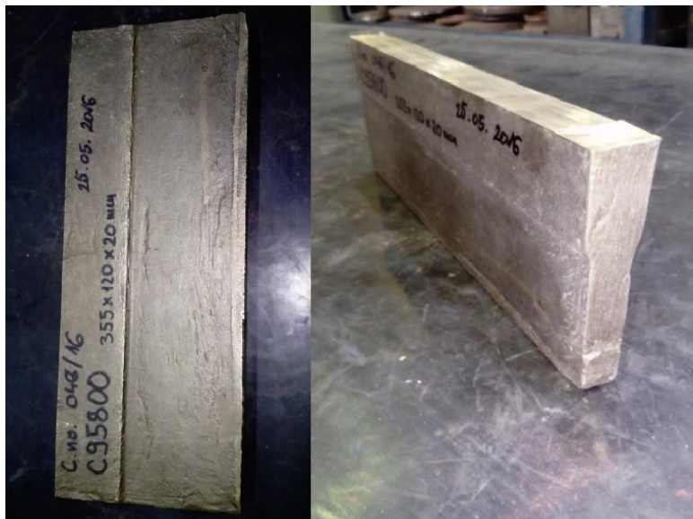
Slika 12. Osnovni materijal – odljevak CuAl10Fe5Ni5
