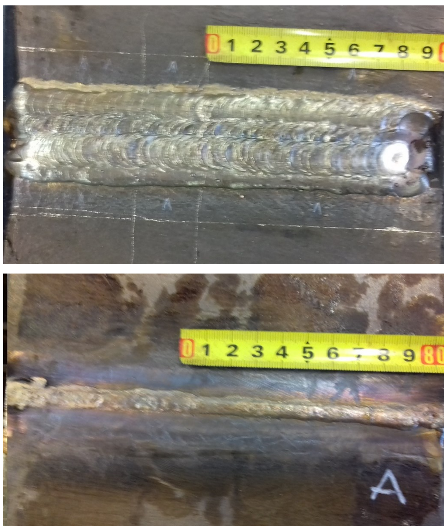
Slika 23. Lice i korijen zavara uzorka A
