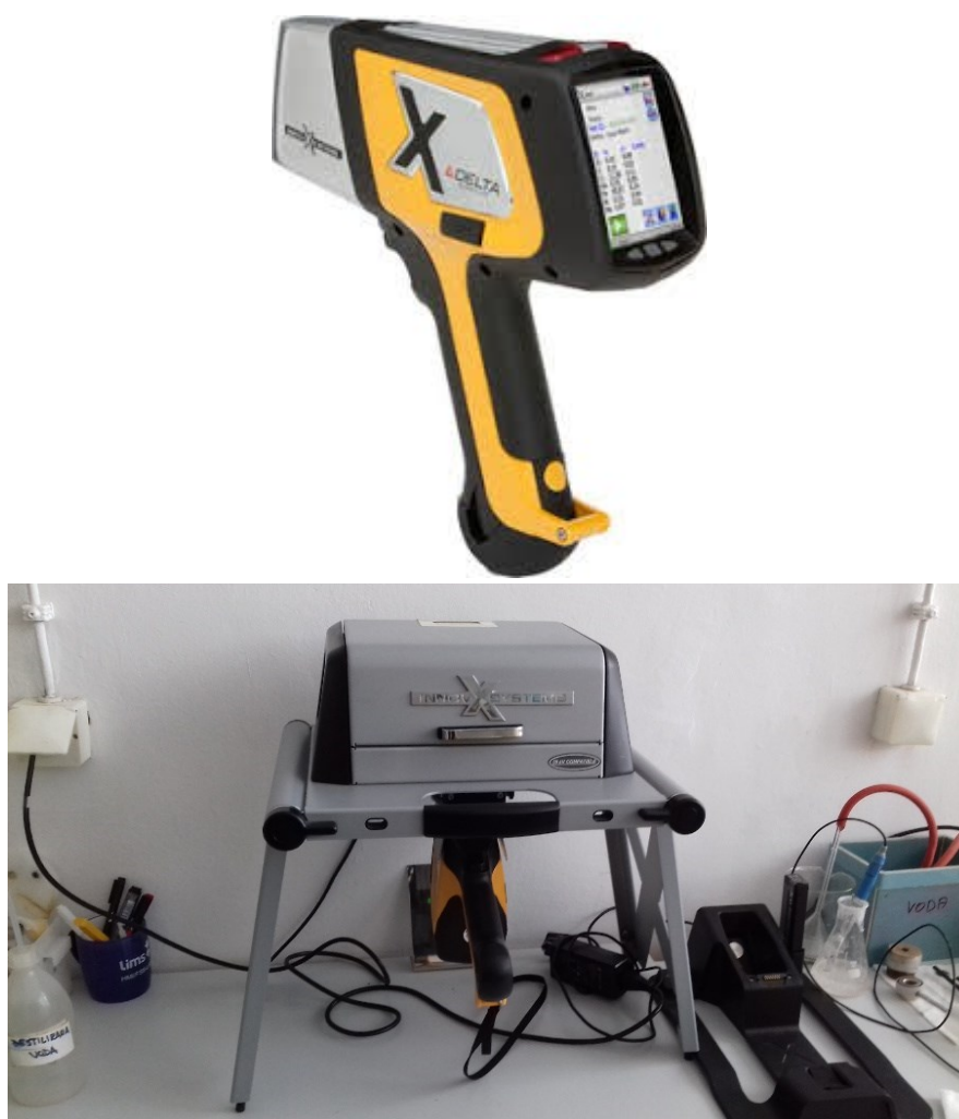
Slika 25. Prijenosni spektroskop Olympus XRF( gore ) i analiza u praksi( ispod )
