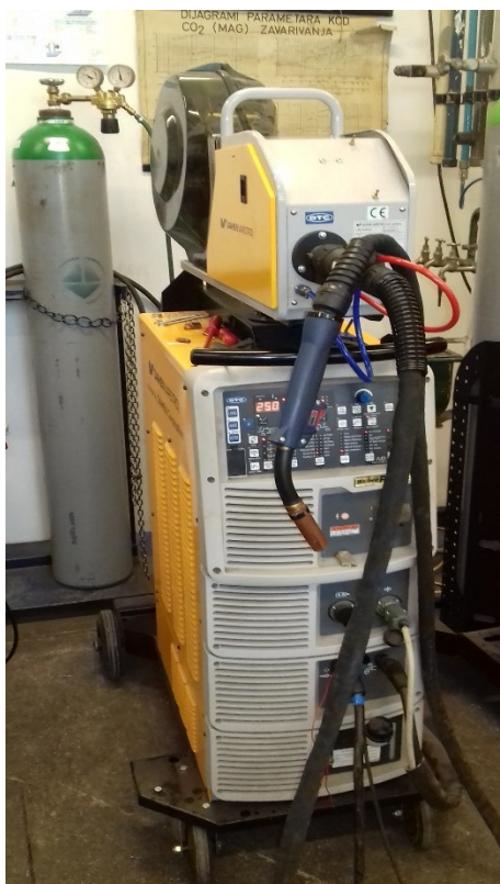
Slika 20. Izvor struje za zavarivanje VARSTROJ Welbee 500L
