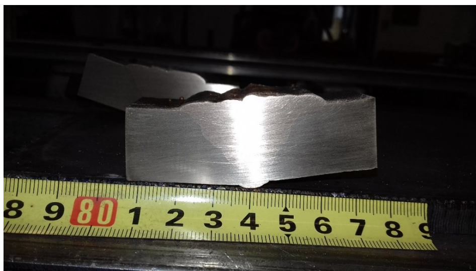
Slika 27. Makroizbrusci nakon brušenja i čišćenja
