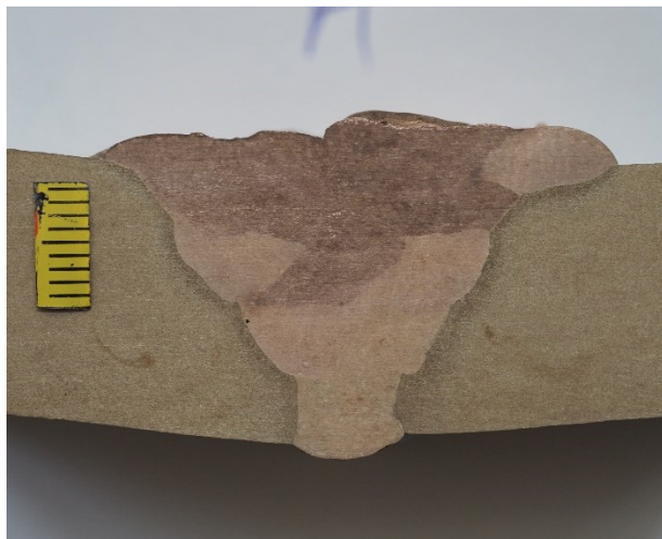
Slika 28. Makroizbrusak uzorka A
