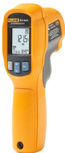
Slika 18. Prijenosni termometar Fluke 568 [10]
