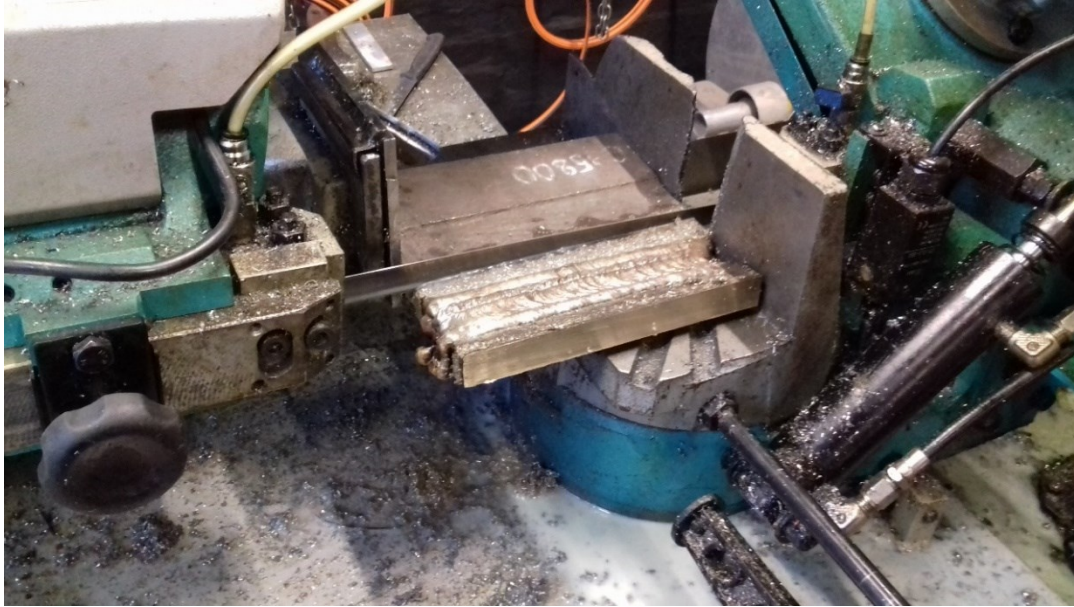
Slika 26. Rezanje ploča na tračnoj pili
