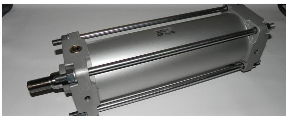
**Slika 11.** Pneumatski cilindar
