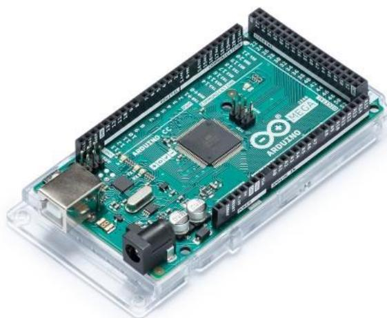
Slika 5. Mikrokontroler Arduino MEGA
