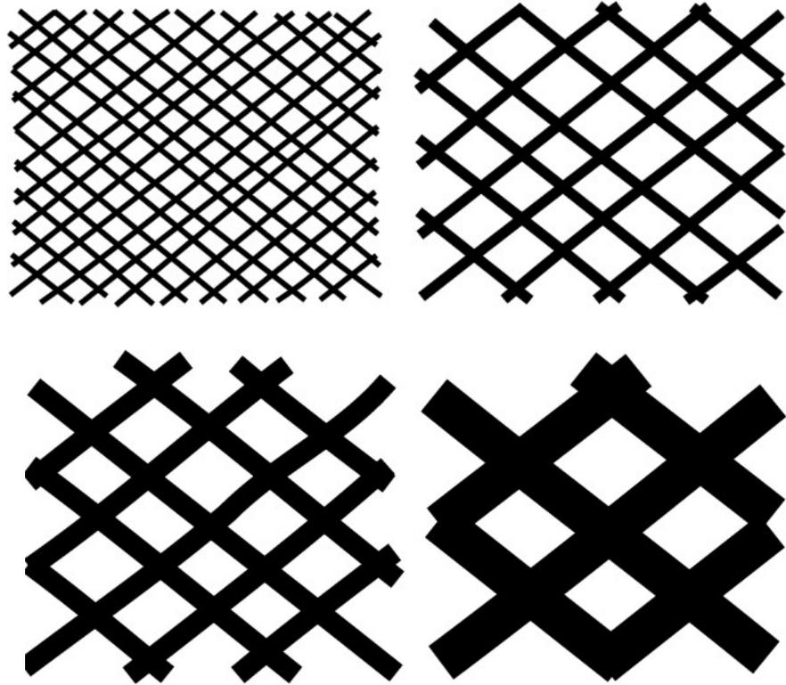
U postavkama za izradu proizvoda može se odrediti stupanj ispunjenosti unutrašnjosti proizvoda. Na taj način može se uštedjeti materijal i ubrzat proces izrade, a sve to bez negativnog utjecaja na funkcionalnost i izdržljivost proizvoda. Odabirom strukture ispune utječe se i na krutost/fleksibilnost proizvoda.
