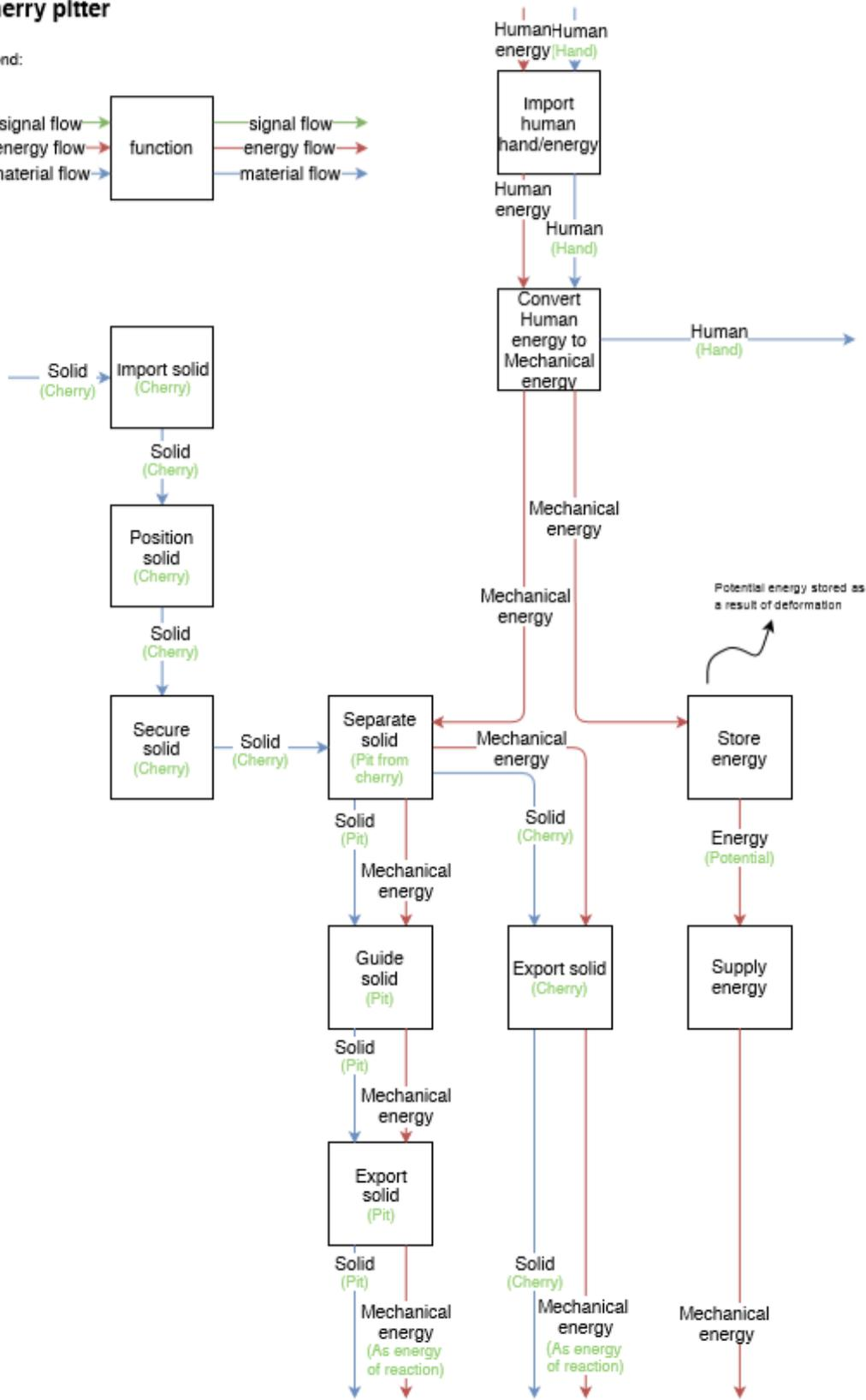
**Slika 3. Funkcijska struktura uređaja za otkošavanje višanja**
