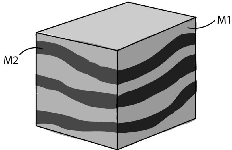
Kod aditivne proizvodnje moguće je koristiti u procesu proizvodnje, ovisno o uređaju za aditivnu proizvodnju, istovremeno dva ili više različitih materijala te tako postići različita svojstva pojedinih dijelova/slojeva proizvoda. Također, drugi materijal može poslužiti i kao potporna struktura.
