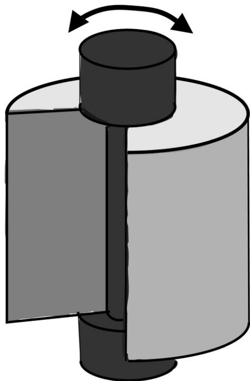
Za ostvarivanje pojedinih funkcija potrebno je omogućiti rotacijsko gibanje sastavnih elemenata proizvoda unutar samog proizvoda, što je aditivnom proizvodnjom moguće postići zbog mogućnosti izrade funkcionalnih sklopova gdje se sve komponente rade istovremeno bez potreba za naknadnim sklapanjem.
