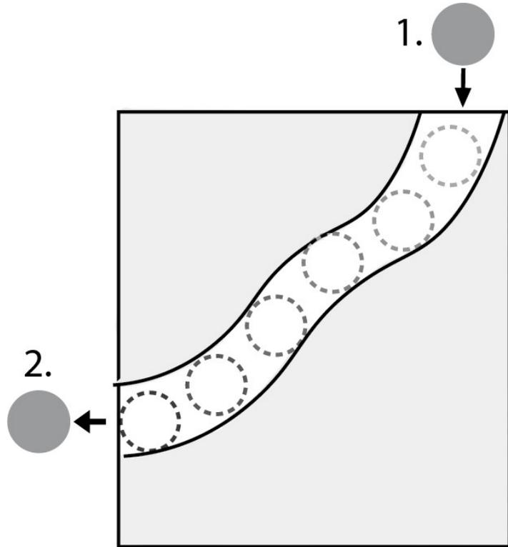
Kod primjene aditivne proizvodnje omogućena je izrada kompleksnih oblika geometrije proizvoda s manje ograničenja nego kod konvencionalnih proizvodnih tehnologija. Stoga se oblik proizvoda može prilagoditi obliku dinamičkog objekta te omogućiti vođenje objekta na vanjskim, ali i unutarnjim površinama proizvoda.
