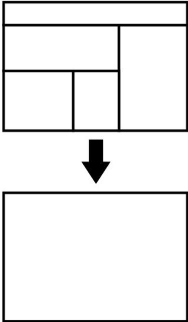
Umjesto da se za svaku funkciju izrađuje zasebna komponenta aditivnom proizvodnjom moguće je u većoj mjeri nego kod tradicionalnih metoda proizvodnje provesti tzv. solidifikaciju. Umjesto da se komponente izrađuju zasebno i kasnije spajaju, one se integriraju, ovisno o kompleksnosti, u jednu ili više većih komponenta. Tako se povećava robusnost proizvoda, smanjuje potreba za naknadnim spajanjem.
