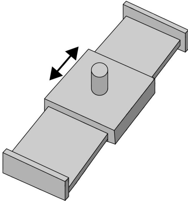
Za ostvarivanje pojedinih funkcija potrebno je omogućiti linearno gibanje sastavnih elemenata proizvoda unutar samog proizvoda, što je aditivnom proizvodnjom moguće postići zbog mogućnosti izrade funkcionalnih sklopova gdje se sve komponente rade istovremeno bez potrebe za naknadnim sklapanjem.
