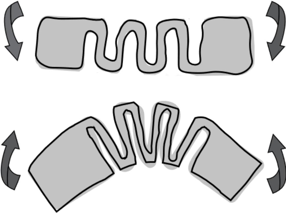
Primjenom aditivne proizvodnje moguće je prilagoditi distribuciju materijala tako da se postigne fleksibilnost proizvoda gdje je to potrebno korištenjem debljih i tanjih dijelova/stijenki.
