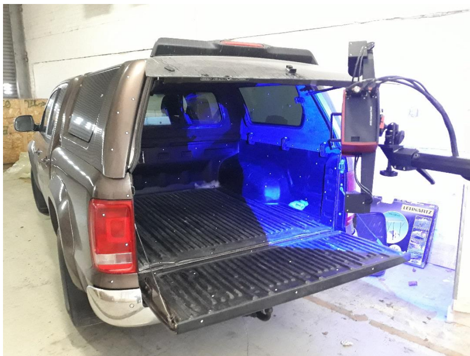
Slika 10. Postupak mjerenja 3D skenerom
