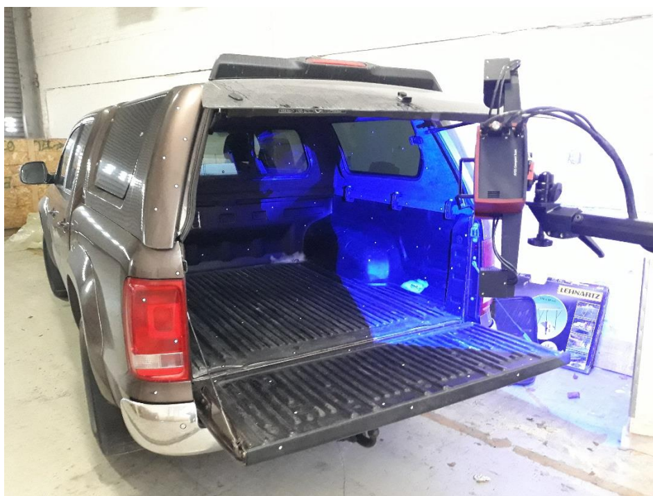
Slika 10. Postupak mjerenja 3D skenerom
