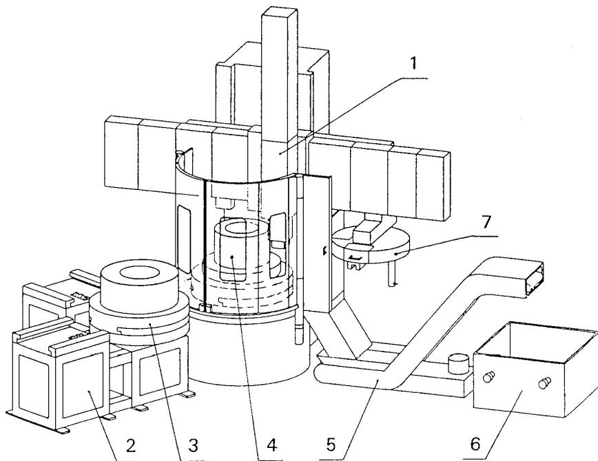
Slika 42. Vertikalni tokarski obradni centar [20]
