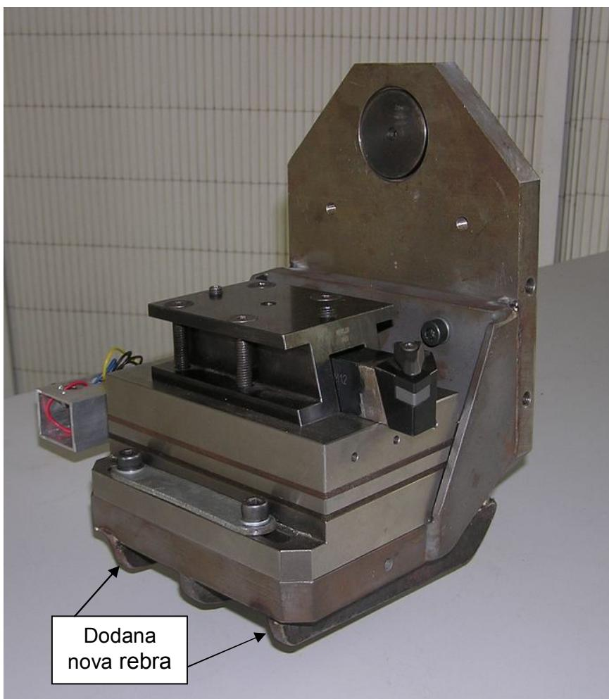
Slika 59. Poboljšana naprava za prihvatom mjerača sila
