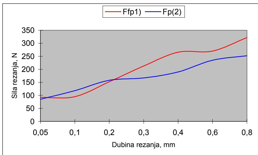
Slika 74. Ovisnost natražne sile  $F_p$  o dubini rezanja za 1. i 2.mjerjenje
