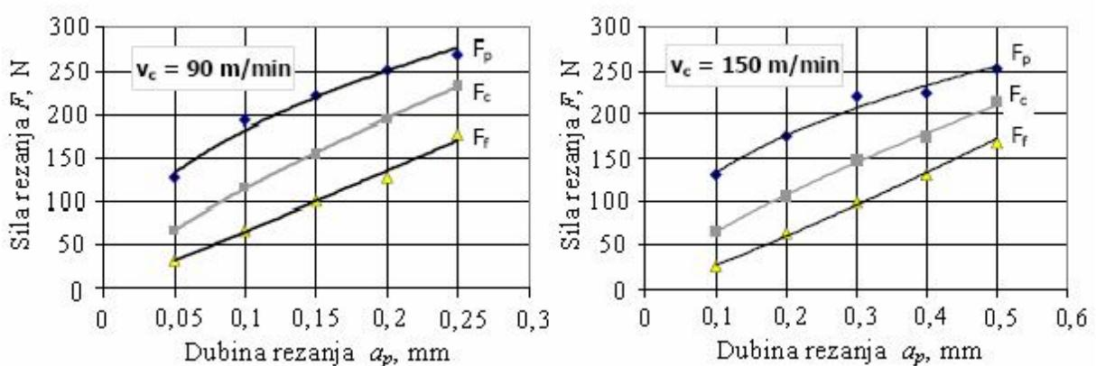
Slika 25. Utjecaj dubine rezanja na sile rezanja [17]
