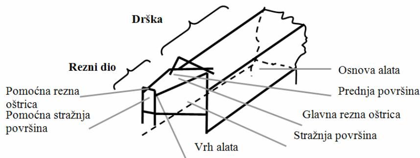
Slika 3. Osnovni elementi alata za rezanje [4]
