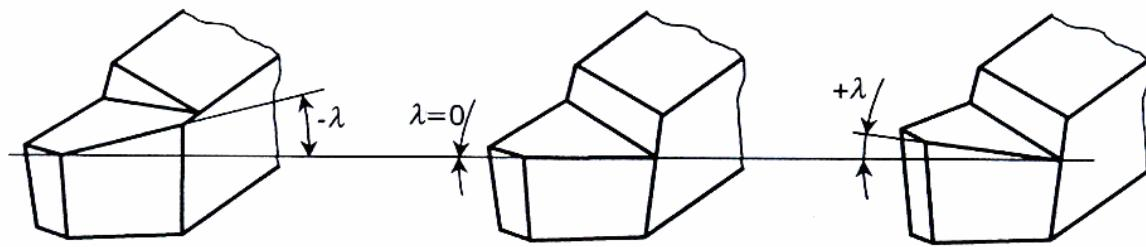
Slika 5. Kut nagiba oštice alata kod tokarskog noža [4]
