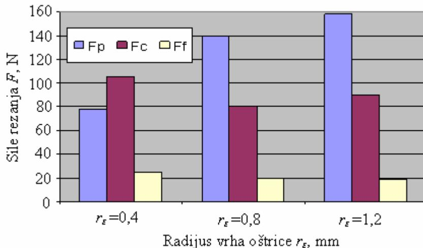
Slika 23. Ovisnost sile rezanja o radiju vrha rezne oštice [16]
