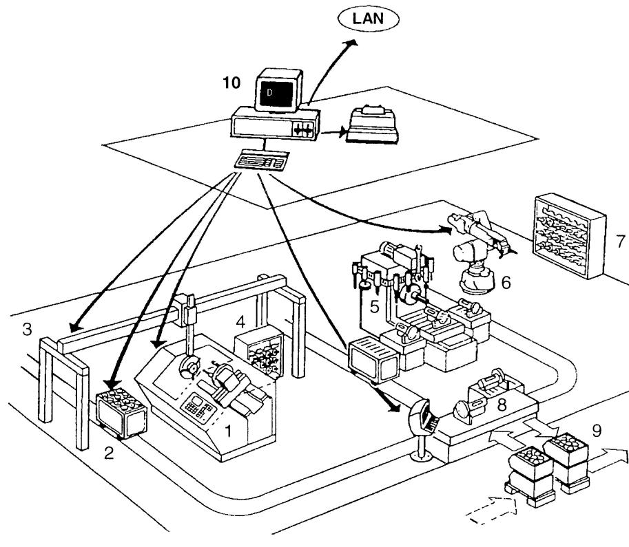
Slika 46. Shema upravljanja fleksibilne obradne čelije [1]
