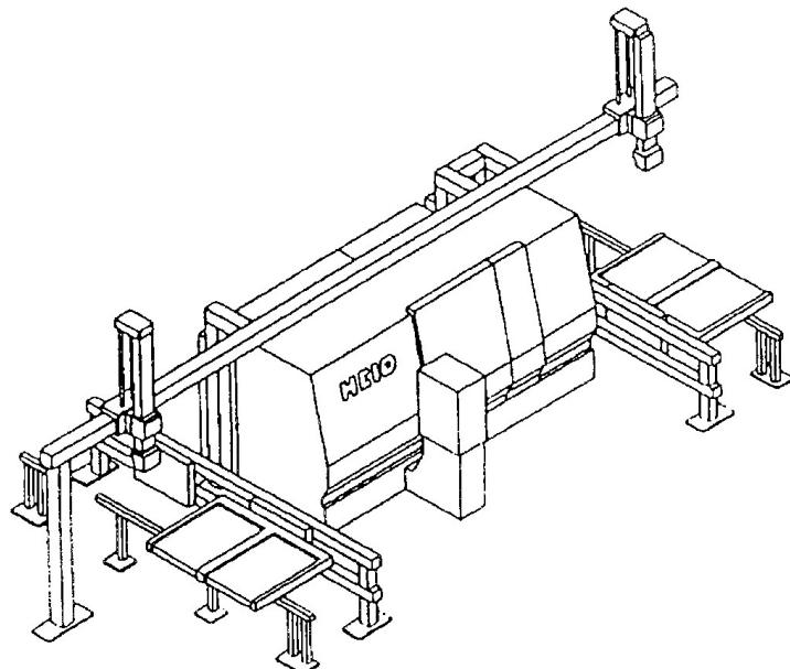
Slika 45. Shema tokarske obradne ćelije FMS 530 proizvođača Heid [1]
