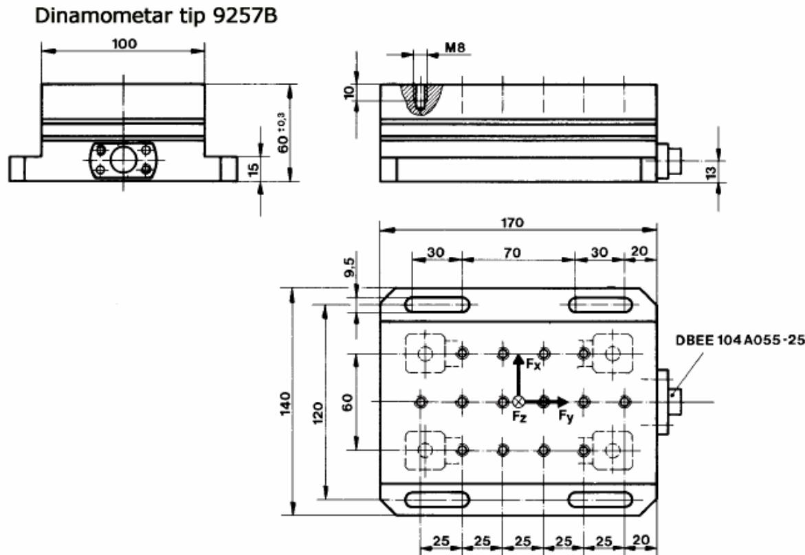
Slika 51. Dimenziije uređaja za mjerjenje sila rezanja [28]
