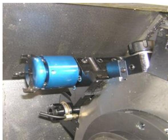
Slika 37. Uređaj za izvlačenja šipkastog materijala [21]
