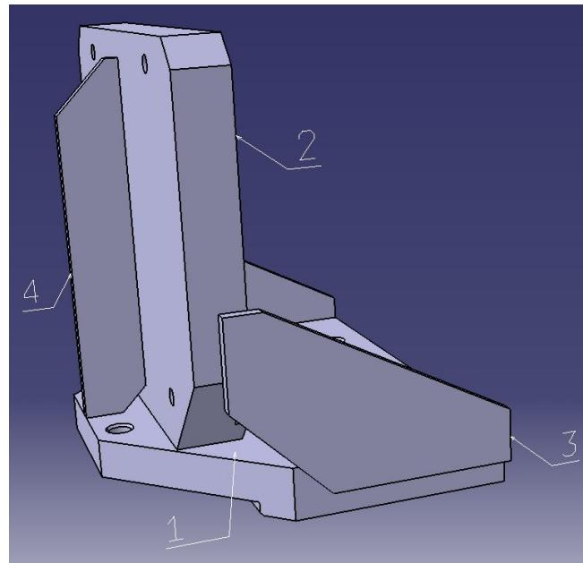
Slika 55. Pomoćna naprava na koju se steže trokomponentni mjerač sila.
