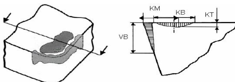
Slika 13. Parametri trošenja [10]
