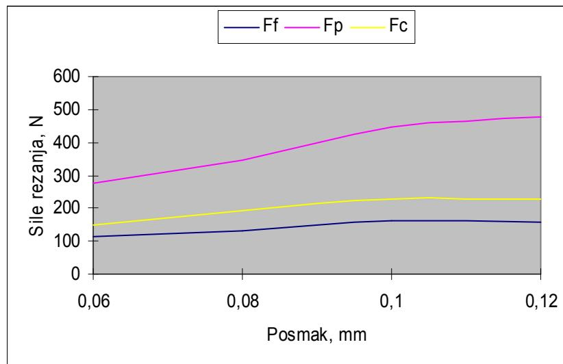
Slika 57. Sile rezanja u ovisnosti o posmaku [30]
