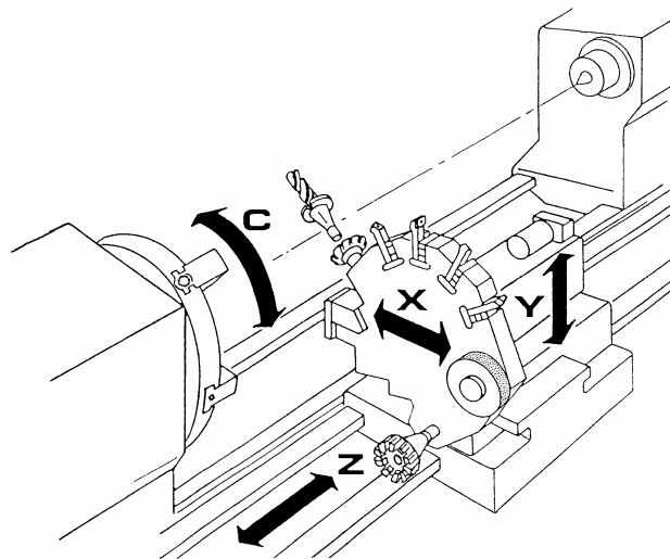
Slika 32. Shema tokarskog obradnog centra [13]
