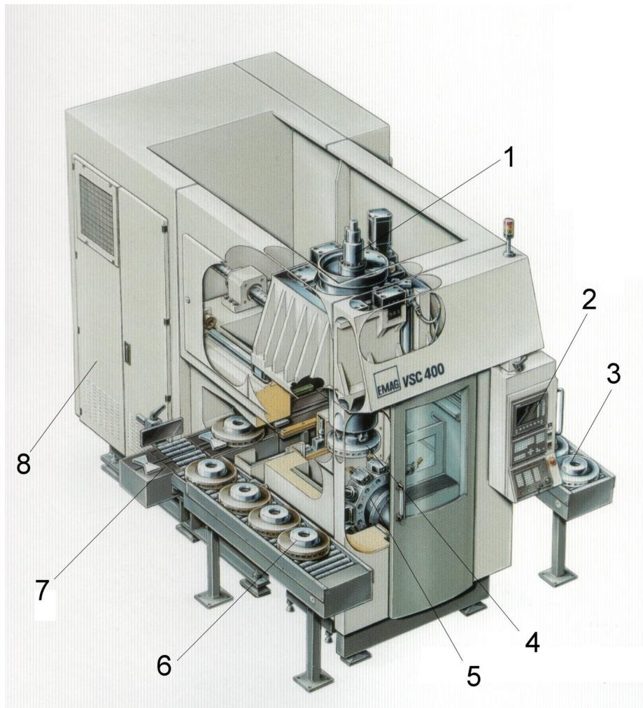
Slika 47. Vertikalna tokarska obradna čelija VSC 400 proizvođača Emag [25]
