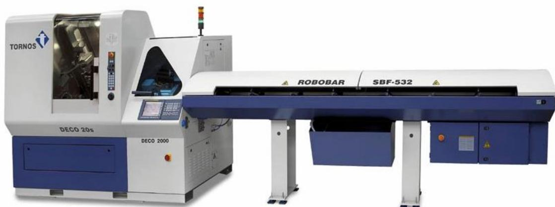
Slika 41. Horizontalni TOC proizvođača Tornos [24]
