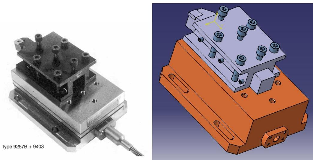
Slika 50. Uređaj za mjerjenje sila rezanja
