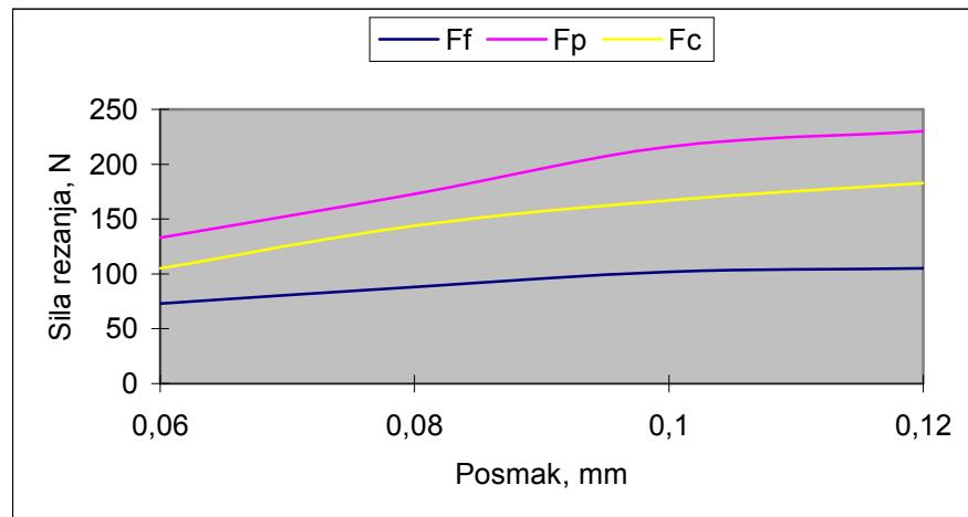
Slika 63. Sile rezanja u Pokusu A za 2. mjerjenje
