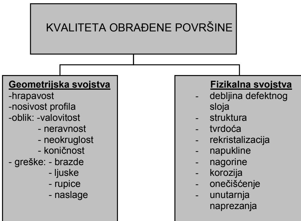
Slika 14. Kvaliteta obrađene površine [12]
