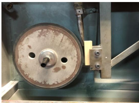
Slika 4.3 Prikaz uzorka postavljenog u čeljust naprave neposredno prije početka ispitivanja
