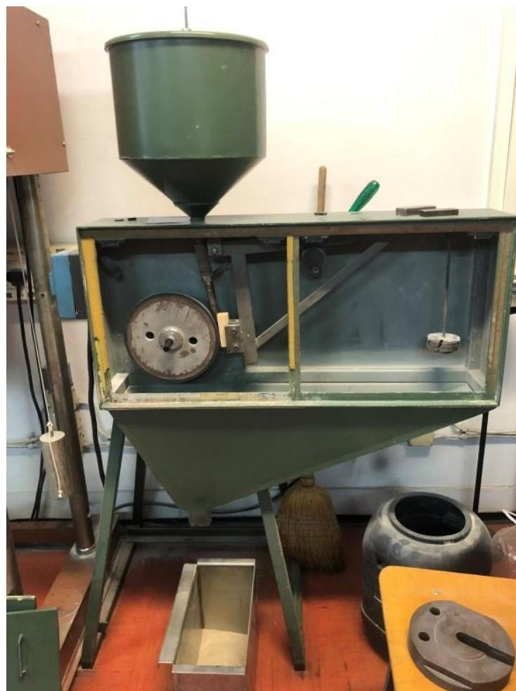
**Slika 4.1 Uredaj za ispitivanje abrazijskog trošenja „Suhu pjesak – gumeni kotač“**
