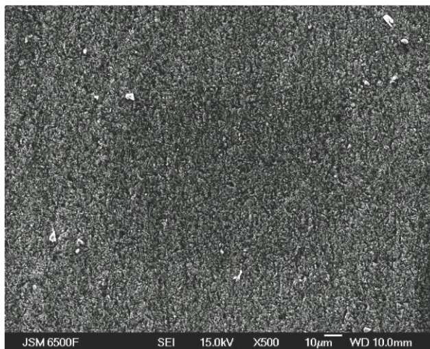
Slika 14 SEM slika trošene površine kod abrazijske sa tri tijela [16]
