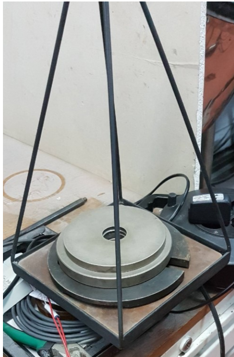
Slika 23 Utezi postavljeni na nosač
