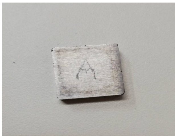
Slika 18 Uzorak tvrdog metala WC-5Co
