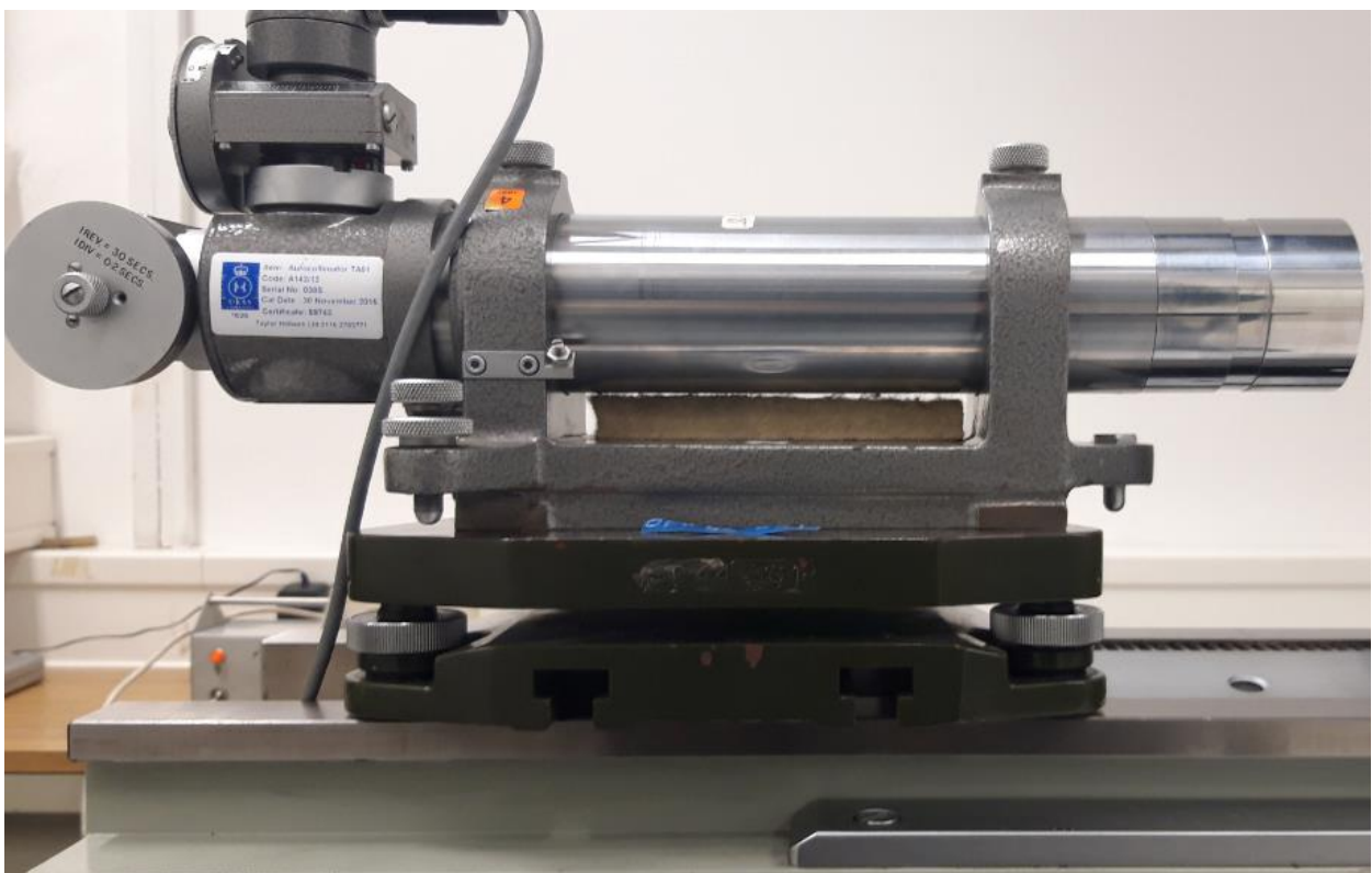
Slika 19. Dio mjernog sustava s autokolimatorom
