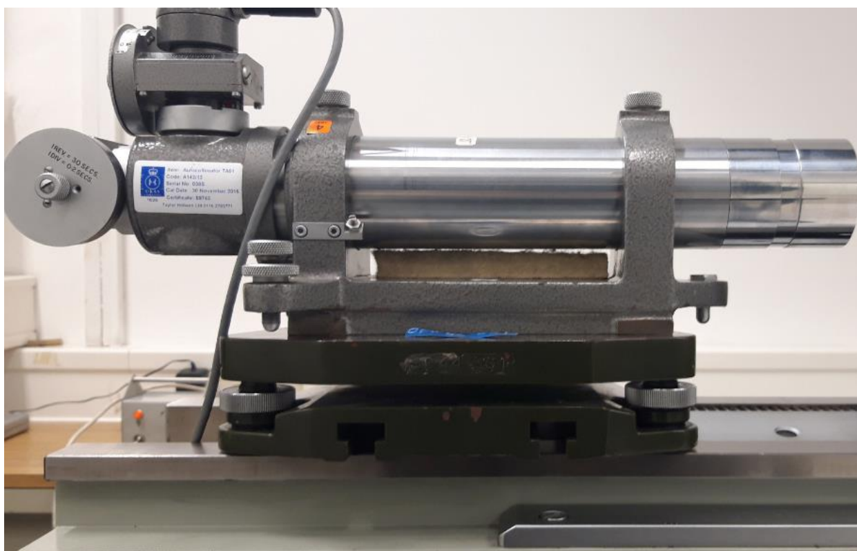
Slika 19. Dio mjernog sustava s autokolimatorom
