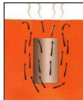
Slika 7. Faze ohlađivanja obratka u sredstvu koje podliježe pojavi nastanka parnog omotača [6]
