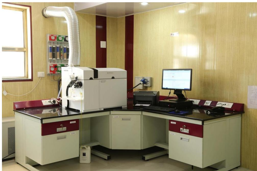
**Slika 9. Primjer laboratorija za ICP spektroskopiju [12]**
