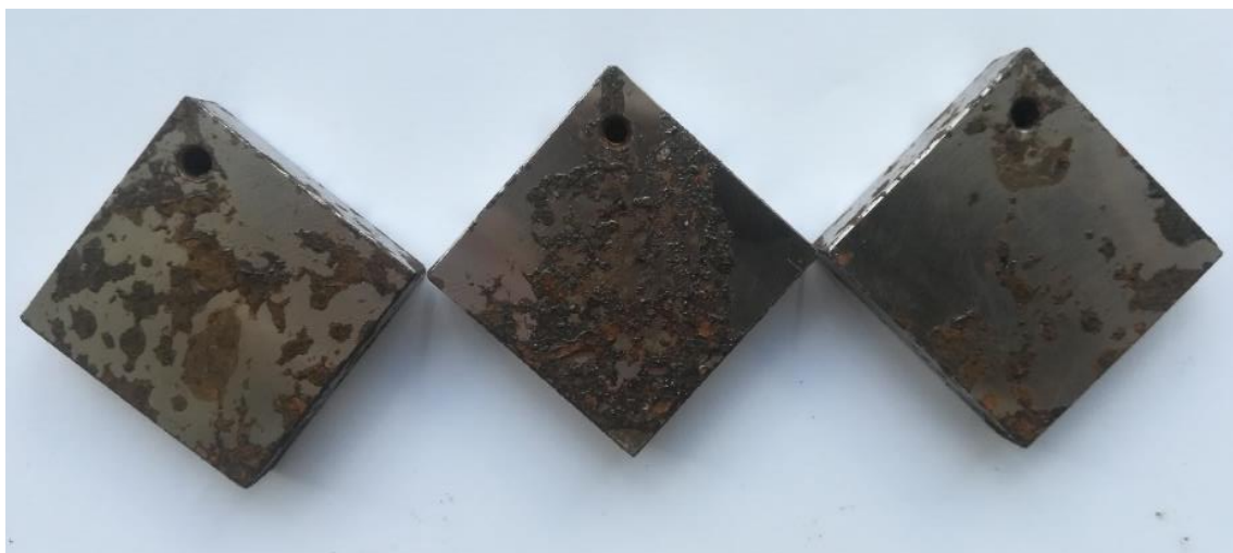
Slika 35. Uzorci nakon ispitivanja u kiseloj kiši
