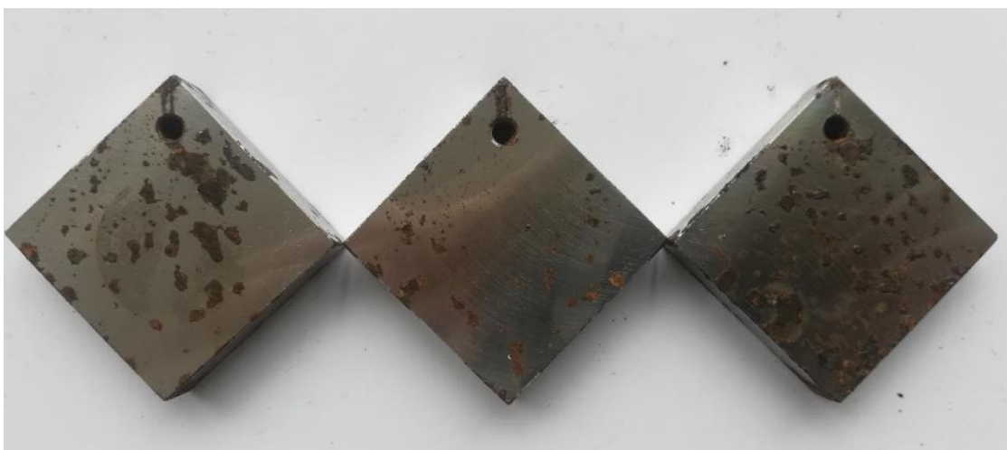
Slika 33. Uzorci nakon ispitivanja u destiliranoj vodi
