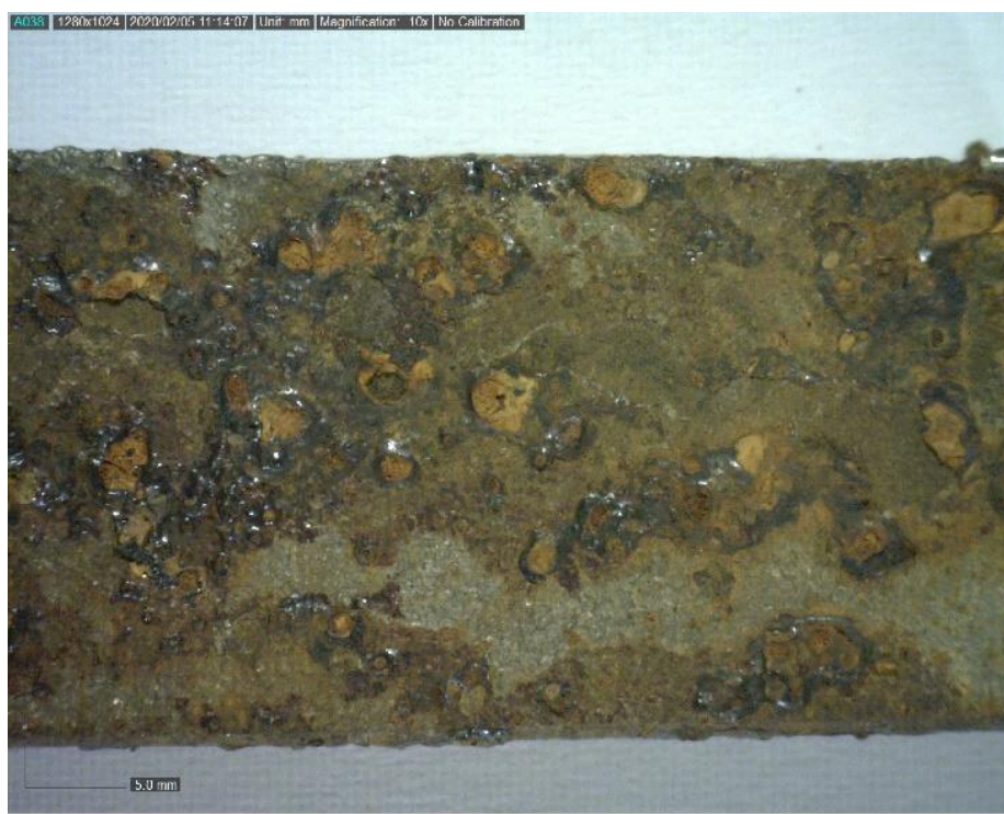
Slika 41. Površina nepoglodanog uzorka ispitivanog u morskoj vodi
