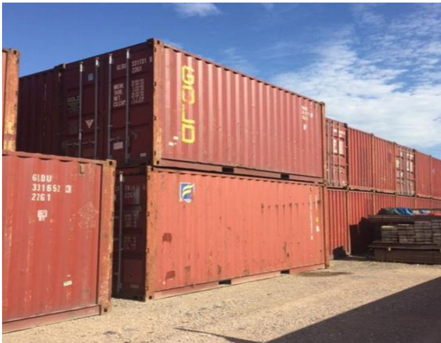
Slika 11. Kontejneri od Corten čelika [26]
