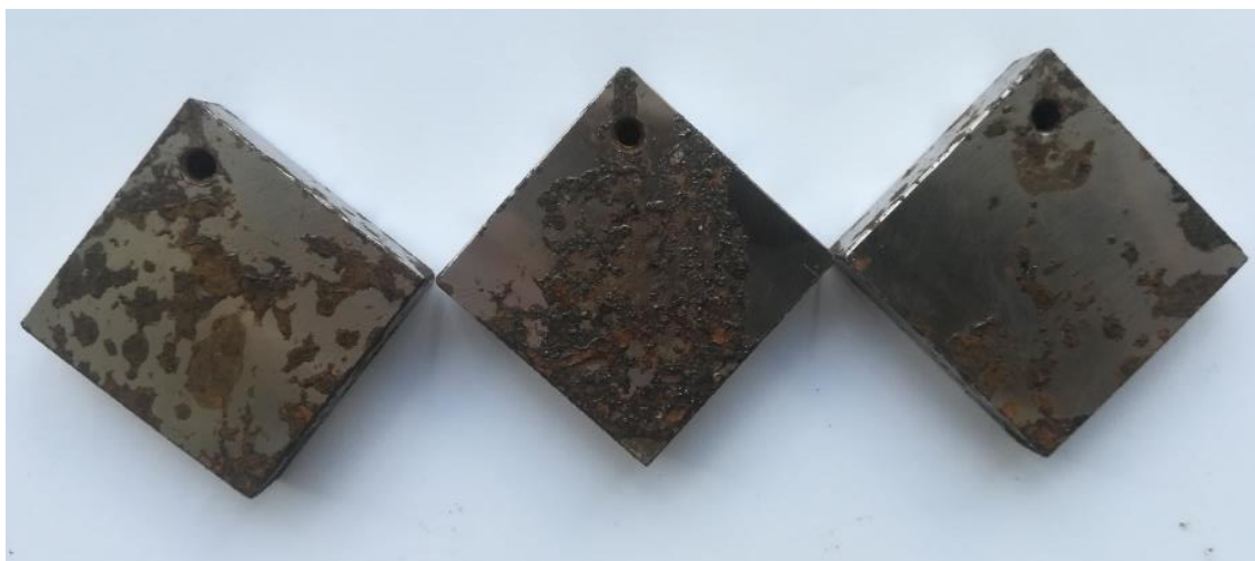
Slika 35. Uzorci nakon ispitivanja u kiseloj kiši
