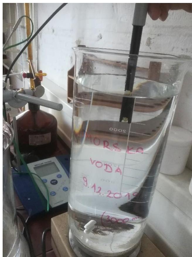
Slika 18. Uređaj za mjerenje pH-vrijednosti Mettler Toledo EL20-Kit
