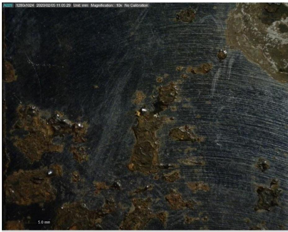
Slika 36. Površina uzorka nakon ispitivanja u kiseloj kiši
