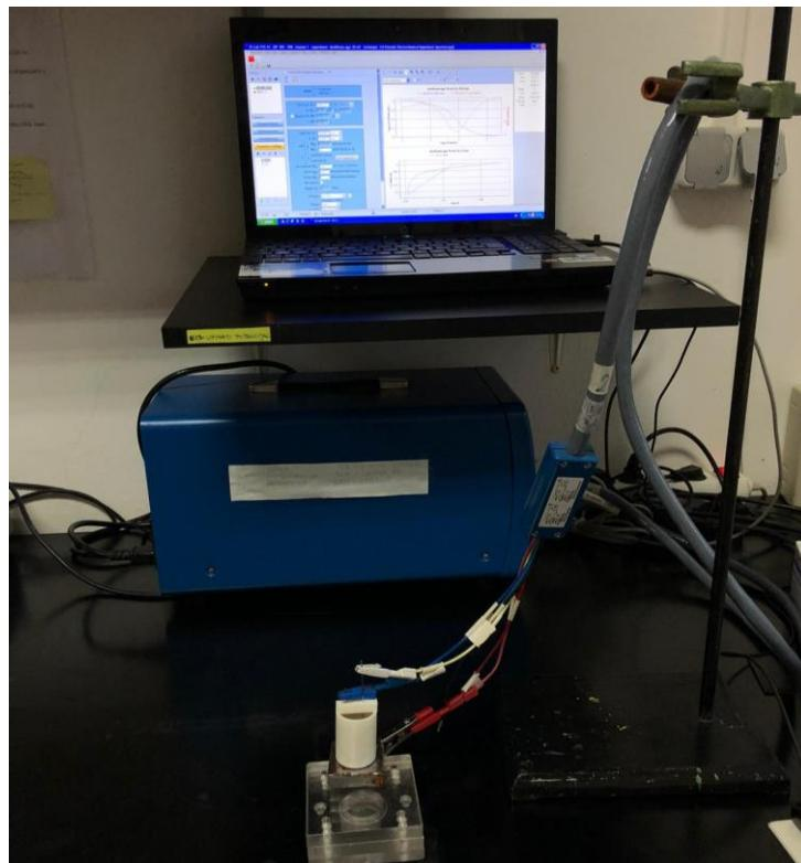
Slika 26. Potenciostat korišten za mjerjenje impedancije BioLogic SP-300
