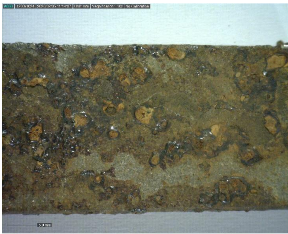
Slika 41. Površina nepoglodanog uzorka ispitivanog u morskoj vodi
