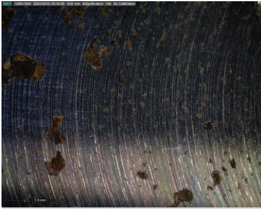
Slika 34. Površina uzorka nakon ispitivanja u destiliranoj vodi
