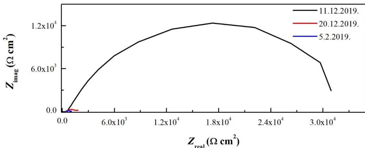
**Slika 43.** Nyquist Dijagram Corten čelika ispitana u destiliranoj vodi
