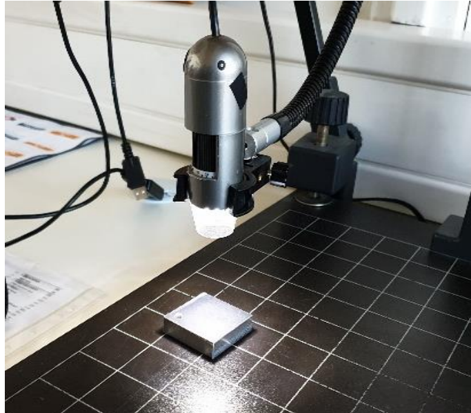
Slika 22. Dino-Lite (digital microscope pro)
