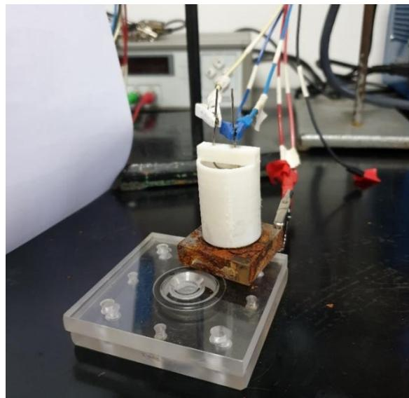
Slika 25. Ispitivanje Corten čelika elektrokemijskom impedancijskom spektroskopijom
