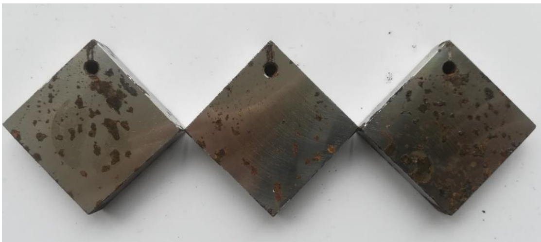
Slika 33. Uzorci nakon ispitivanja u destiliranoj vodi
