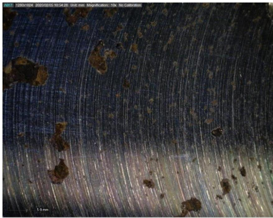
Slika 34. Površina uzorka nakon ispitivanja u destiliranoj vodi
