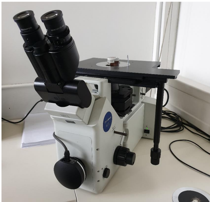
Slika 23. Svjetlosni mikroskop Olympus GX51
