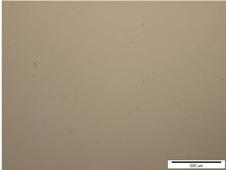
**Slika 27.** Mikrostruktura osnovnog materijala u poliranom stanju
