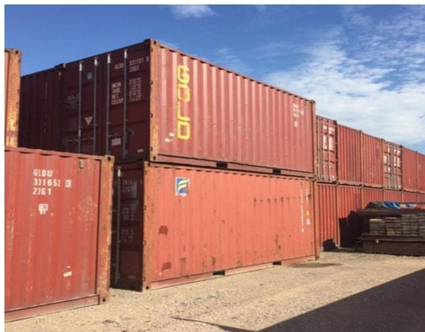
Slika 11. Kontejneri od Corten čelika [26]
