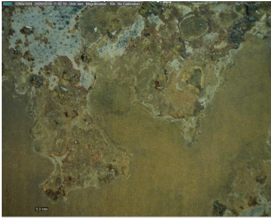
Slika 38. Površina uzorka nakon ispitivanja u morskoj vodi
