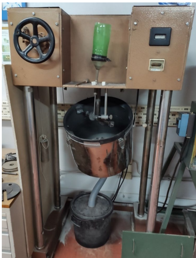
Slika 45. Uređaj za ispitivanje otpornosti na eroziju česticama
