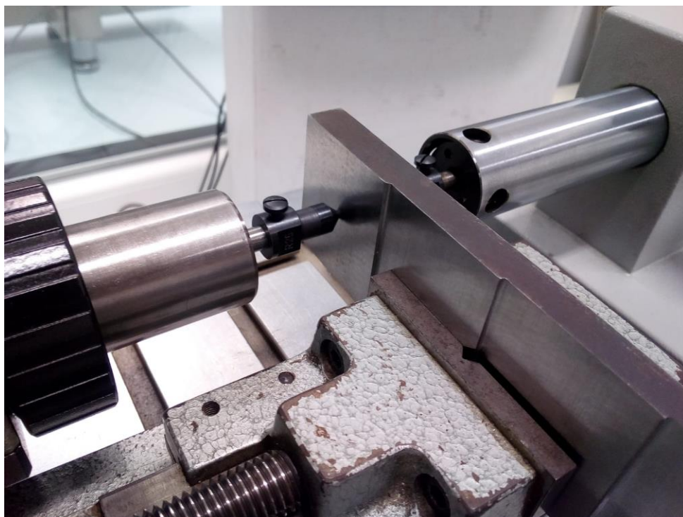
Slika 11. Provedba mjerenja jednoosnim mjernim uređajem
