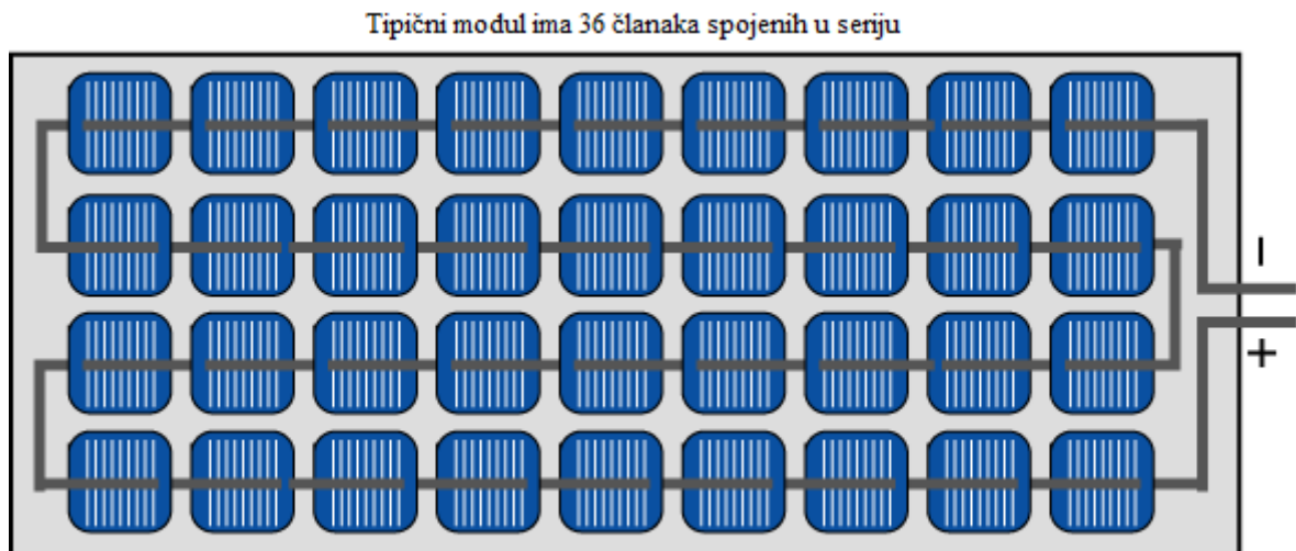
Slika 3. Raspored FN članaka u modulu (za poli i monokristalne FN module) [4]
