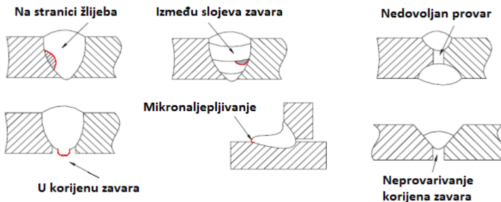
Slika 13. Naljepljivanje (lijevo) i nedovoljan provar (desno) [14]
