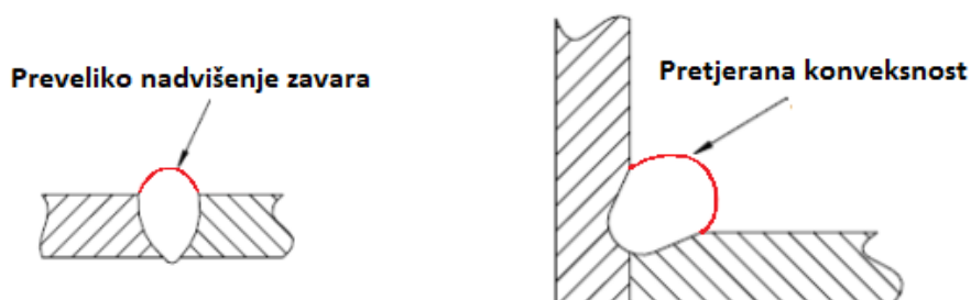
Slika 14. Pogreške oblika zavora [14]
