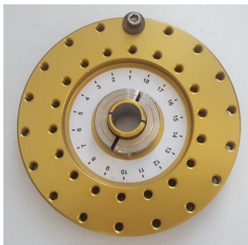
Slika 5.1 Rotor za simulaciju debalansa
