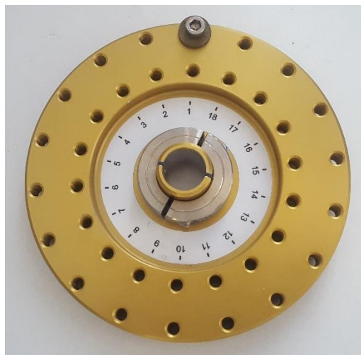
Slika 5.1 Rotor za simulaciju debalansa
