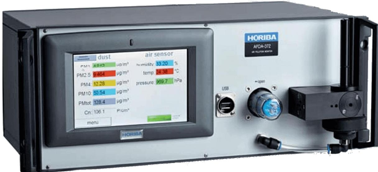
Slika 7 - APDA-372 uređaj za mjerjenje koncentracije lebdećih čestica [23]
