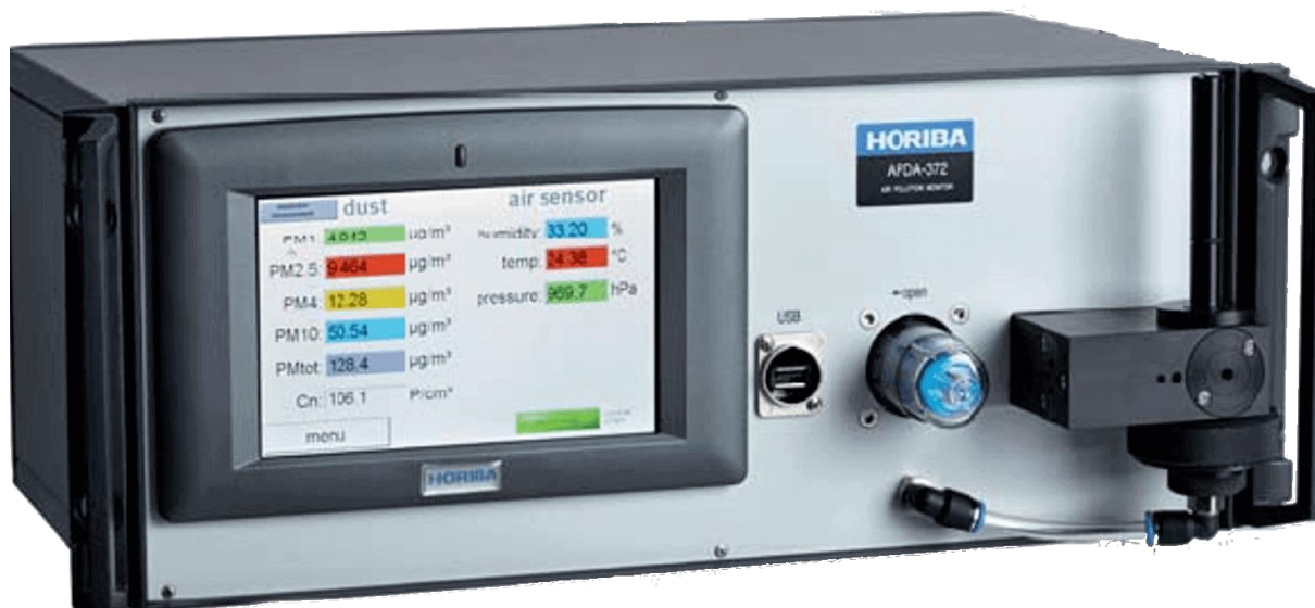
Slika 7 - APDA-372 uređaj za mjerenje koncentracije lebdećih čestica [23]
