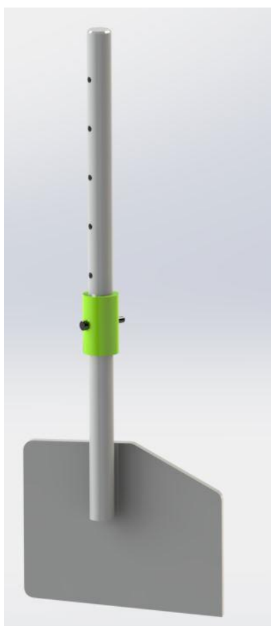
Slika 34. Podsklop traktorskog donjeg prihvata
