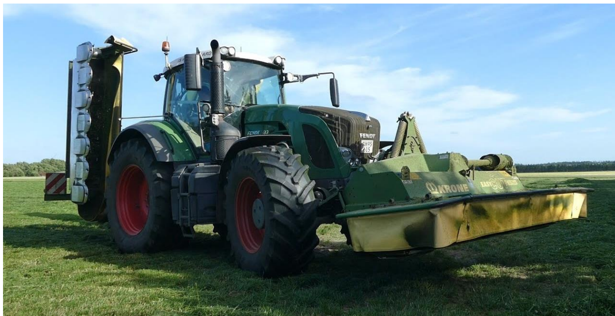
Slika 7. Traktor sa prednjim i zadnjim priključkom i kardanom
