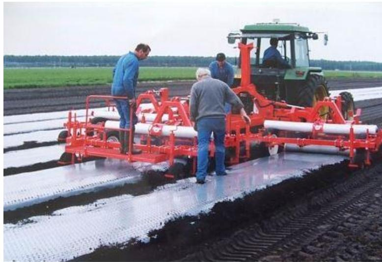
**Slika 16. "ID" laying machine - nadogradnja za potavljanje tri reda u jednom prolazu**
