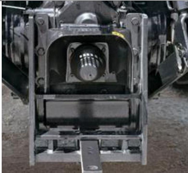
**Slika 8. Izlazni priključak za radno vratilo**
